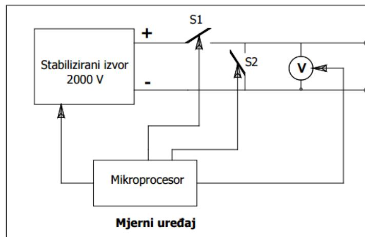
Slika 12. Shema uređaja za mjerjenje spektra polarizacije
