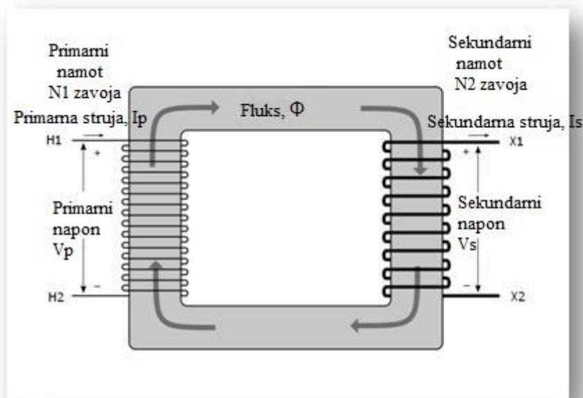
Slika 2. Presjek i princip rada transformatora
