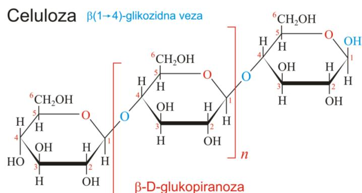
Slika 6. Prikaz glukopiranozne jedinice u celuloznom lancu
