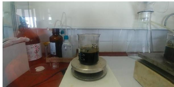
Slika 19 Adsorpcija uz T3 pri sobnoj temperaturi
