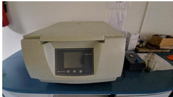
Slika 13 Centrifuga za naftu i mineralna ulja Normalab
