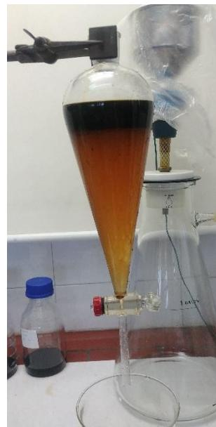
Slika 17 Odijeljivanje slojeva u lijevku za odijeljivanje
