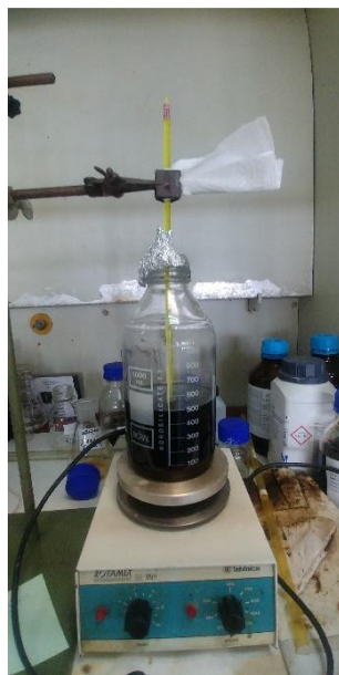
Slika 14 Ekstrakcija srednje frakcije ulja pomoću DES8
