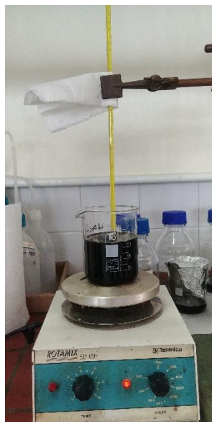
Slika 15 Desulfurizacija ulja pomoću HAc:H 2 O 2
