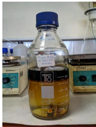
Slika 16 Ispiranje ulja destiliranim vodom
