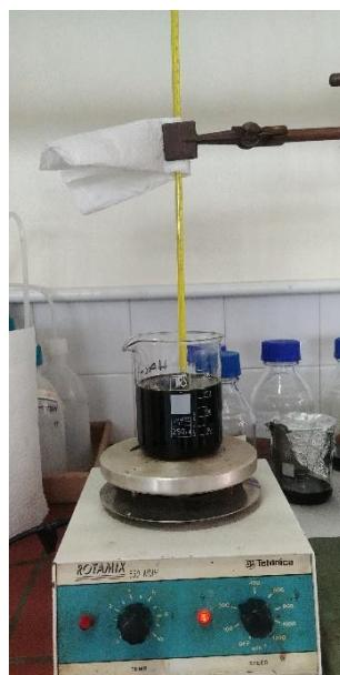
Slika 15 Desulfurizacija ulja pomoću HAc:H<sub>2</sub>O<sub>2</sub>
