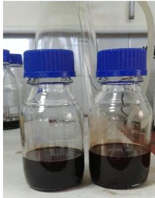
Slika 18 Gornji slojevi nakon desulfurizacije uz  $H_2SO_4$
