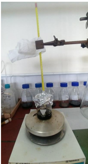
Slika 20 Ekstrakcijska desulfurizacija uz DES 2
