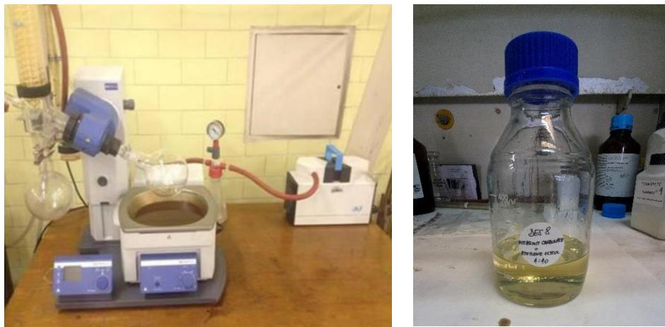
*Slika 10 Vakuum isparivač (lijevo) pripremljeno otapalo (desno)*
