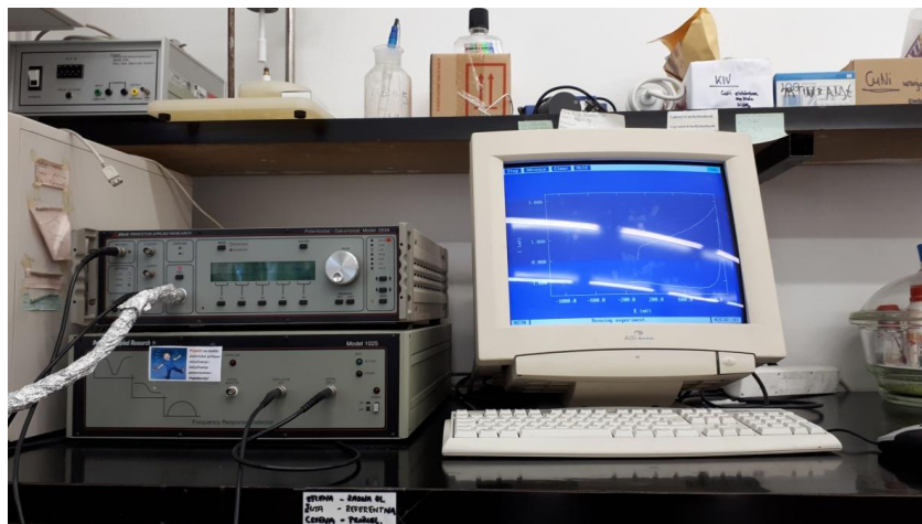
Slika 3.9. Aparatura za elektrokemijska ispitivanja; potenciostat EG&G Princeton Applied Research, model 263 A
