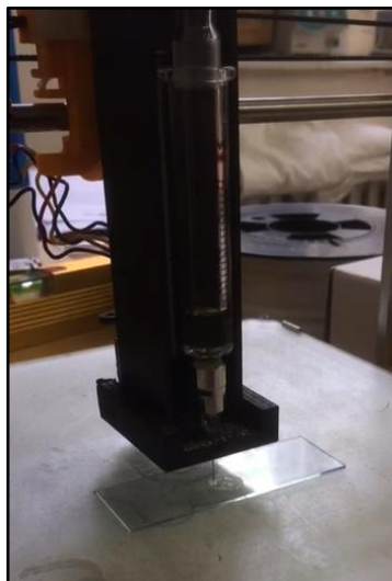
Slika 14. Inicijalni testovi tiskanja jednostavnih oblika gelovima.
