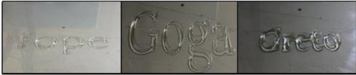
Slika 27. Fotografije uzoraka tiskane iglom promjera G22 uz protok 50 % lijevo, 100 % sredina, 300 % desno.
