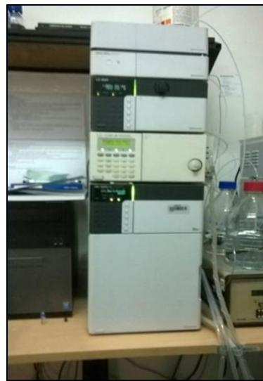
Slika 11. HPLC uređaj *Shimadzu*
