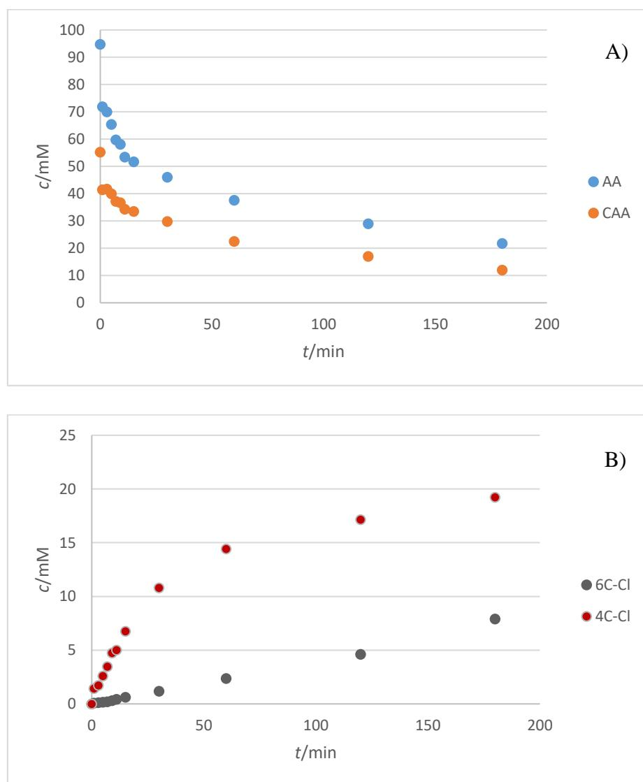
Slika 24. Promjena koncentracije supstrata (A) i produkata (B) u reakciji dvostrukе aldolne adicije acetaldehida i kloracetaldehida katalizirane DERA-om imobilizirane na magnetskim nanočesticama obloženih mezoporoznom silikom, te aktivirane benzokinonom. ( $V = 0,2 \text{ mL}$ ,  $20 \text{ mg enzima/g nosioca}$ ,  $m_{\text{nosioca}} = 25 \text{ mg}$ ,  $0,1 \text{ M fosfatni pufer pH 6}$ )
