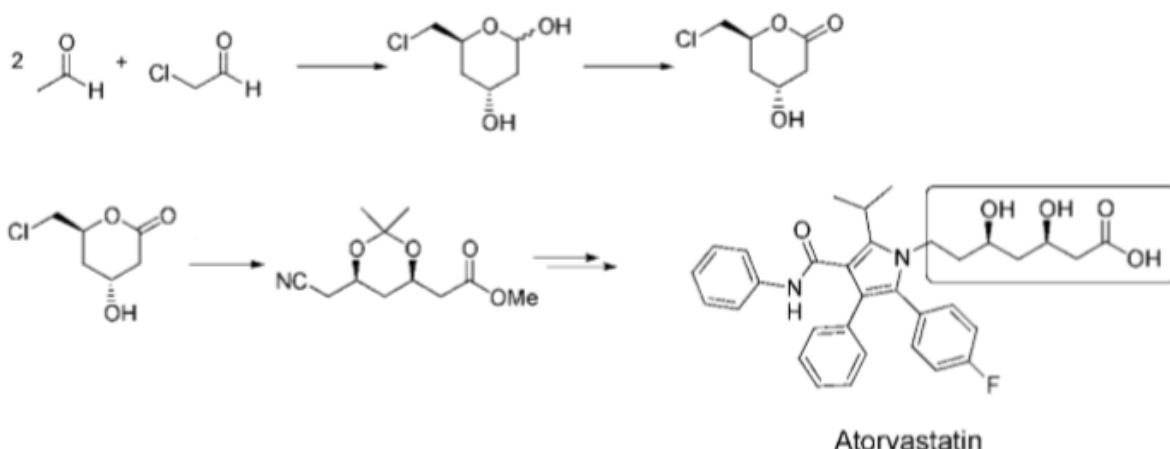
Slika 5. Shema sinteze atorvastatina pomoću enzima DERA <sup>[14]</sup>
