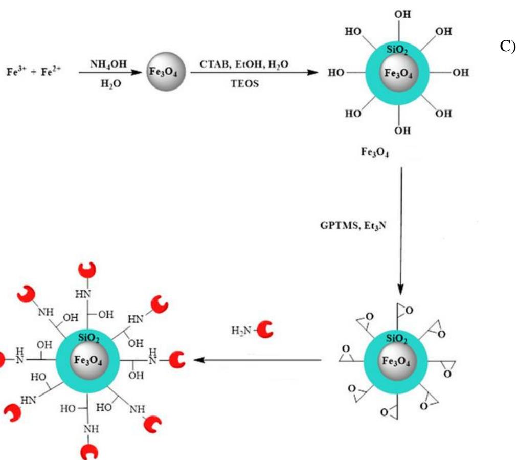
Slika 13. Shema postupaka funkcionalizacije i aktivacije  $\text{SiO}_2$  te immobilizacije enzima za: A) benzokinon, B) glutaraldehid i C) epoksi skupinu (GPTMS)
