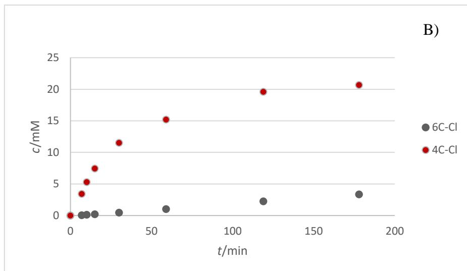
Slika 16. Promjena koncentracije supstrata (A) i produkata (B) u reakciji dvostrukе aldolne adicije acetaldehida i kloracetaldehida katalizirane DERA-om imobilizirane na magnetskim nanočesticama obloženih neporoznom silikom, te aktivirane glutaraldehidom. ( $V = 0,2 \text{ mL}$ ,  $20 \text{ mg}_{\text{enzima}}/\text{gnosioca}$ ,  $m_{\text{nosioda}} = 25 \text{ mg}$ ,  $0,1 \text{ M}$  fosfatni pufer pH 6)
