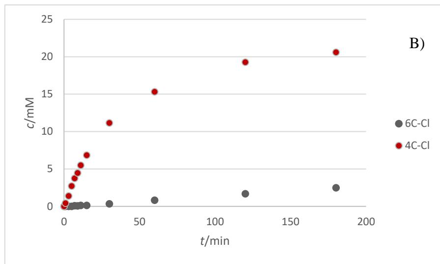
Slika 18. Promjena koncentracije supstrata (A) i produkata (B) u reakciji dvostrukе aldolne adicije acetaldehida i kloracetaldehida katalizirane DERA-om imobilizirane na magnetskim nanočesticama obloženih neporoznom silikom, te aktivirane GPTMS. ( $V = 0,2 \text{ mL}$ ,  $20 \text{ mg}_{\text{enzima}}/\text{g}_{\text{nosioca}}$ ,  $m_{\text{nosioca}} = 25 \text{ mg}$ ,  $0,1 \text{ M}$  fosfatni pufer pH 6)
