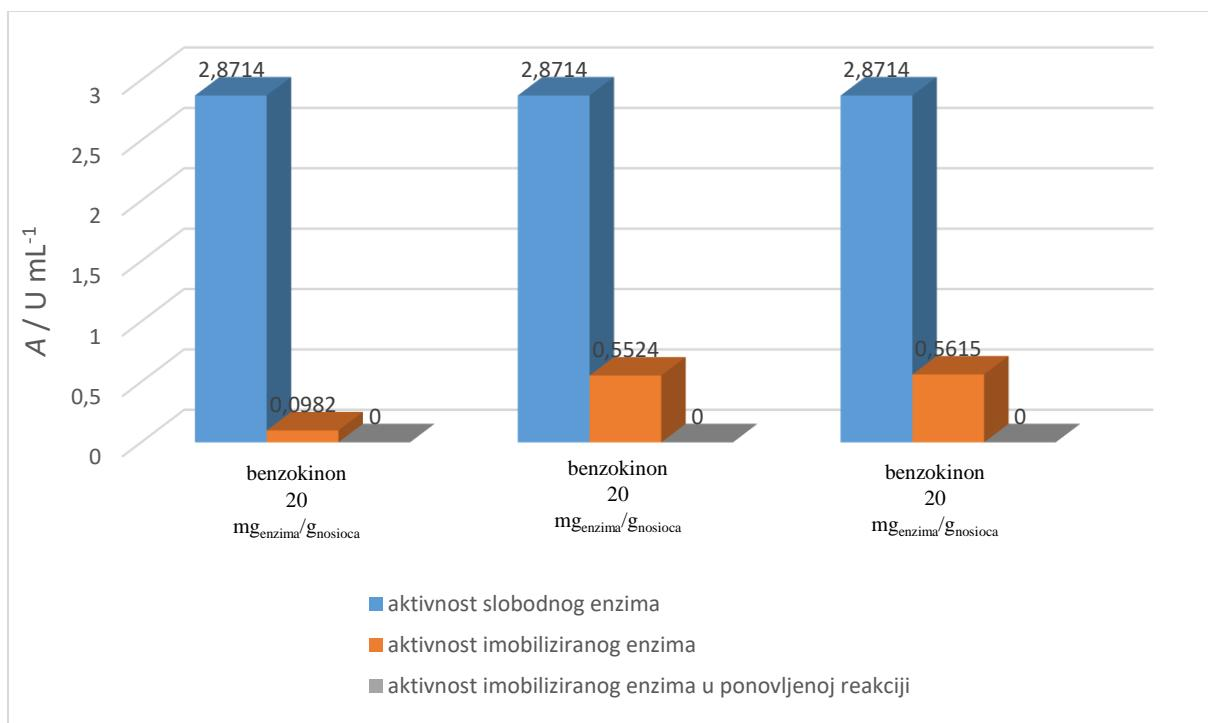
Slika 26. Usporedni prikaz izmjerenih aktivnosti slobodnog enzima, te aktivnosti imobilizirane DERA-e na magnetske nanočestice obložene mezoporoznom silikom funkcionalizirane i aktivirane različitim metodama kao i aktivnosti iste u ponovljenoj reakciji.
