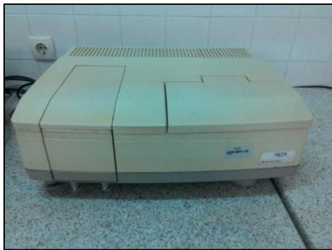
Slika 12. UV/Vis spektrofotometar *Shimadzu UV-1601*
