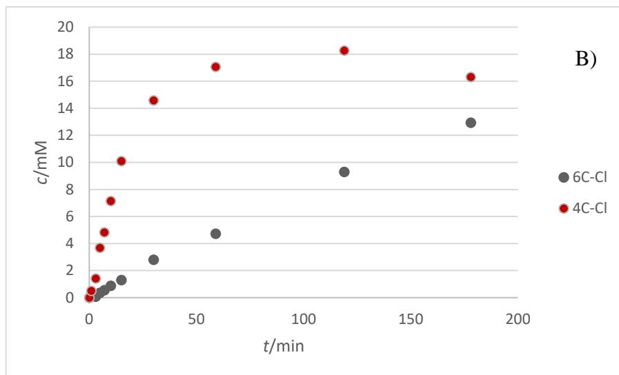
Slika 17. Promjena koncentracije supstrata (A) i produkata (B) u reakciji dvostrukе aldolne adicije acetaldehida i kloracetaldehida katalizirane DERA-om imobilizirane na magnetskim nanočesticama obloženih neporoznom silikom, te aktivirane benzokinonom. ( $V = 0,2 \text{ mL}$ ,  $20 \text{ mg}_{\text{enzima}}/\text{gnosioca}$ ,  $m_{\text{nosiodica}} = 25 \text{ mg}$ ,  $0,1 \text{ M}$  fosfatni pufer pH 6)
