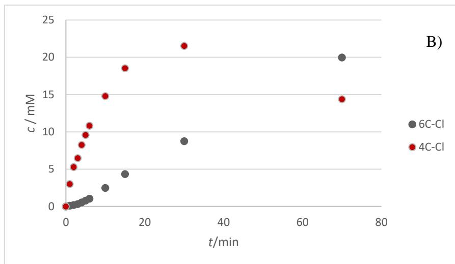
Slika 19. Promjena koncentracije supstrata (A) i produkata (B) u reakciji dvostrukе aldolne adicije acetaldehyda i kloracetaldehyda katalizirane DERA-om imobilizirane na magnetskim nanočesticama obloženih neporoznom silikom, te aktivirane benzokinonom. ( $V = 0,2 \text{ mL}$ ,  $100 \text{ mg}_{\text{enzima}}/\text{gnosioca}$ ,  $m_{\text{nosioda}} = 25 \text{ mg}$ ,  $0,1 \text{ M}$  fosfatni pufer pH 6)
