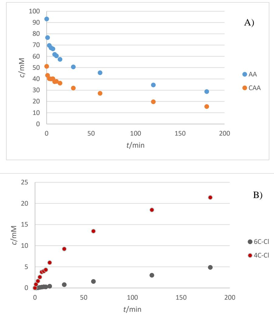
Slika 25. Promjena koncentracije supstrata (A) i produkata (B) u reakciji dvostrukе aldolne adicije acetaldehida i kloracetaldehida katalizirane DERA-om imobilizirane na magnetskim nanočesticama obloženih mezoporoznom silikom, te aktivirane epoksi smolom. ( $V = 0,2 \text{ mL}$ ,  $20 \text{ mg enzima/g nosioca}$ ,  $m_{\text{nosioca}} = 25 \text{ mg}$ ,  $0,1 \text{ M fosfatni bufer pH 6}$ )
