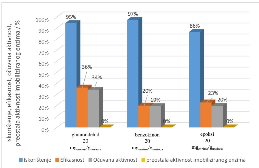
Slika 27. Usporedni prikaz izračunatih parametara uspješnosti immobilizacije DERA na magnetske nanočestice obložene mezoporoznom silikom funkcionalizirane i aktivirane različitim metodama
