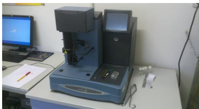
Slika 12. TGA analizator Q500, TA Instruments
