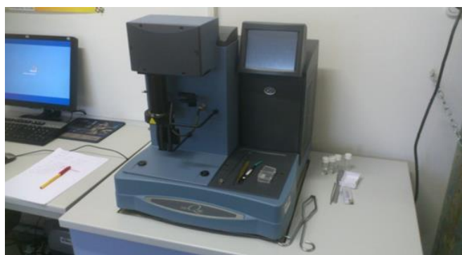
Slika 12. TGA analizator Q500, TA Instruments
