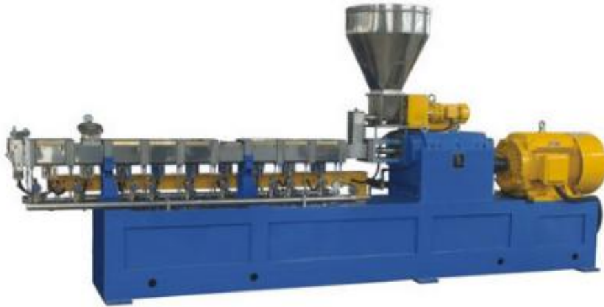
Slika 3. Pužni (vijčani) ekstruder [13]
