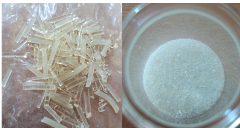
Slika 17. Uzorak CLX-SOL dobiven ekstrudiranjem pri 120 °C (CLX-SOL-120)
