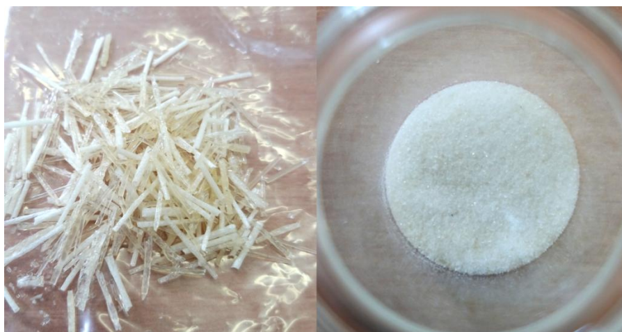
Slika 16. Uzorak CLX-SOL dobiven ekstrudiranjem pri 170 °C (CLX-SOL-170)
