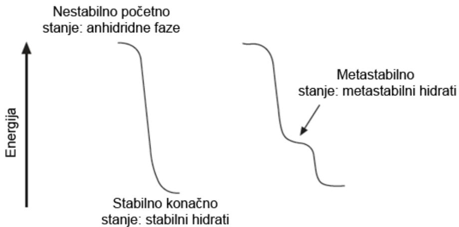
**Slika 2.** Shematski prikaz pojave metastabilne faze i termodinamičke transformacije tijekom hidratacije [2]
