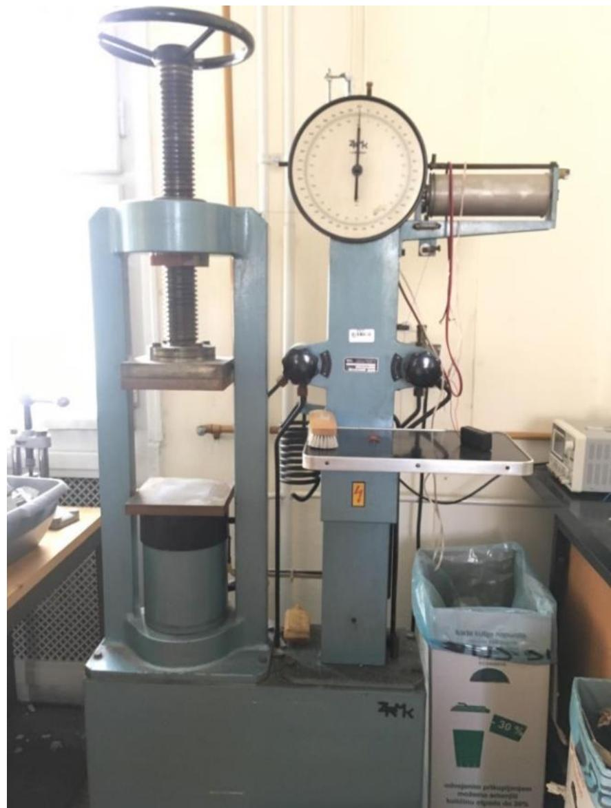
**Slika 13. Hidraulična preša**
