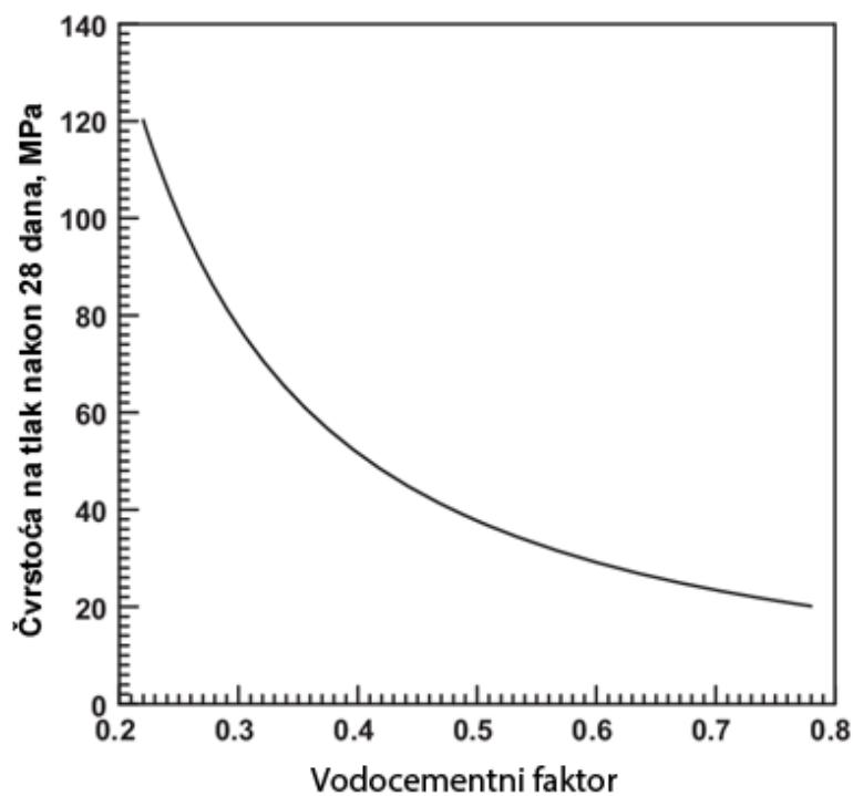
**Slika 7.** Odnos čvrstoće na tlak i vodocementnog faktora [16]
