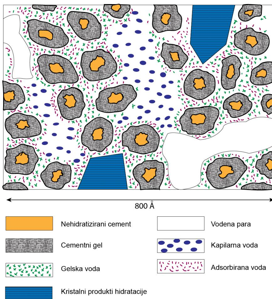
*Slika 5. Struktura očvrsle cementne paste*
