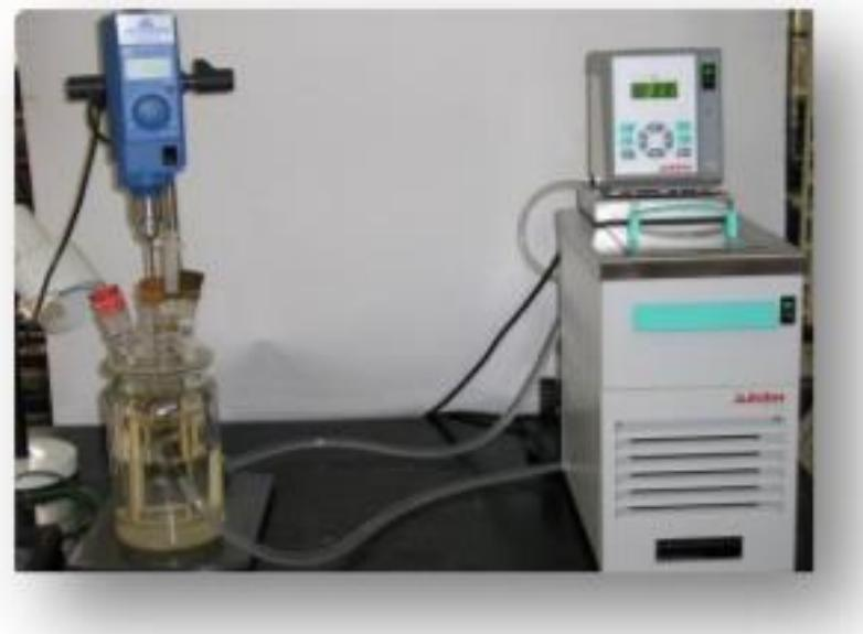
**Slika 3.2.** Aparatura za provedbu prekrystalizacije
