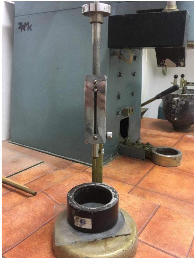
*Slika 12: Vicat aparat za određivanje vremena vezanja*
