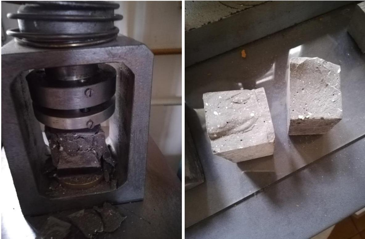
*Slika 18: Bijela zrnca neotopljenog litijeva karbonata vidljiva u slomljenim prizmama pri određivanju čvrstoće na tlak*
