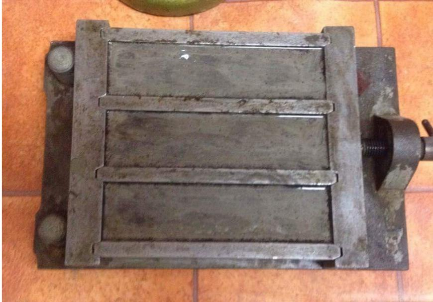
*Slika 13: Trodiyelni kalup ispunjen cementnom pastom*
