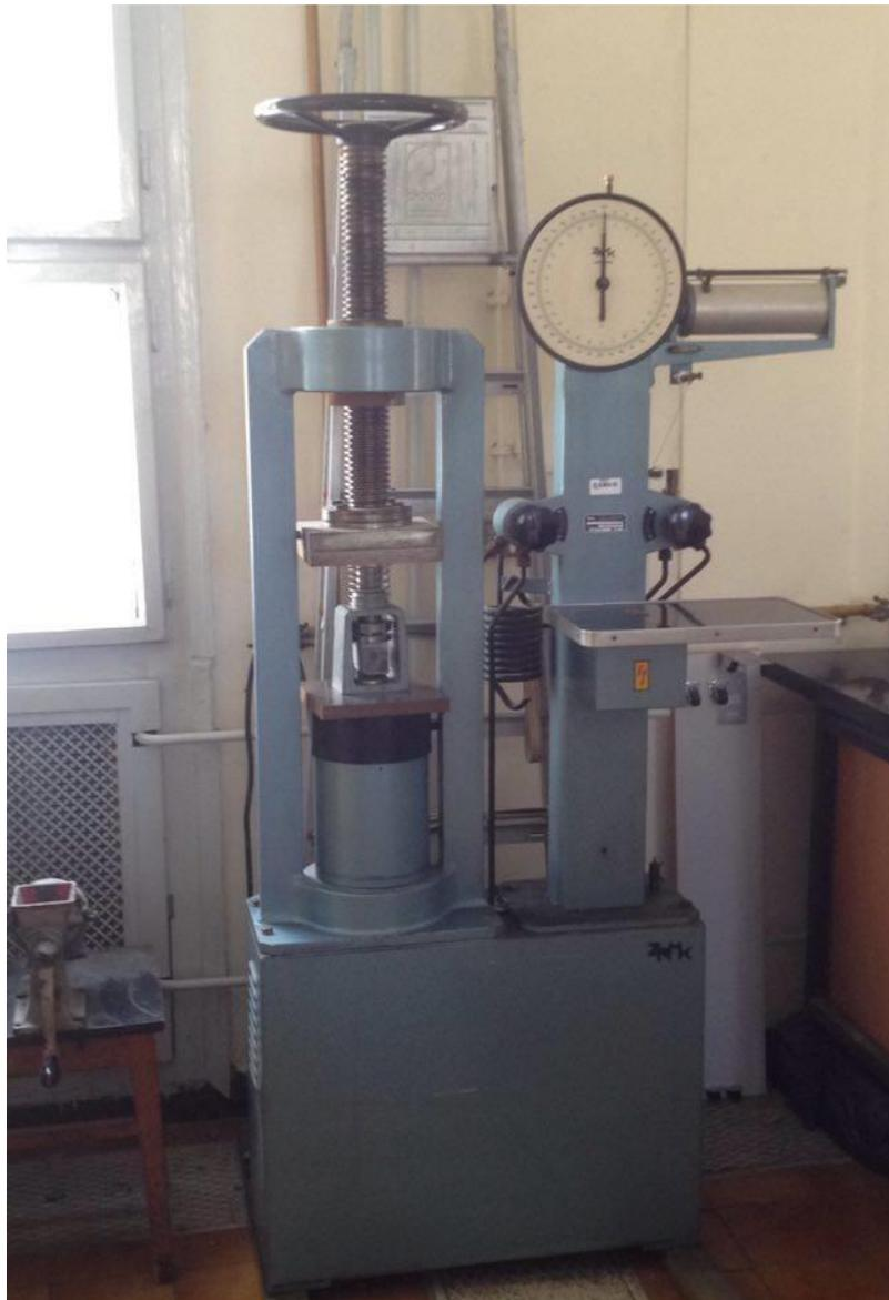
*Slika 14: Hidraulična preša za određivanje čvrstoće na tlak*
