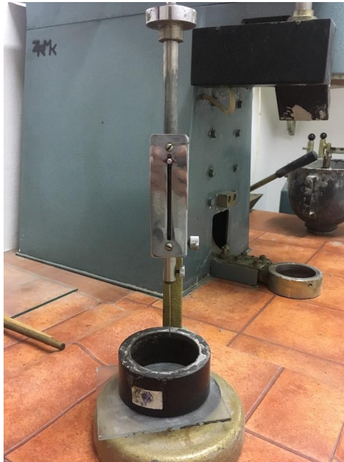
Slika 12: Vicat aparat za određivanje vremena vezanja
