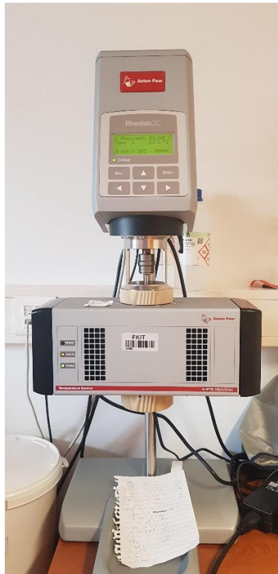
Slika 18. Reometar Anton Paar
