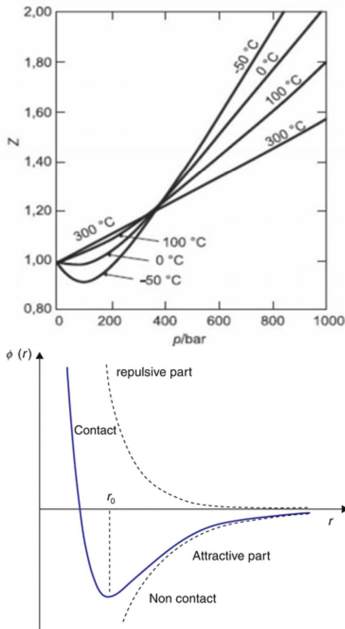
Slika 1. Ovisnost kompresijskog faktora  $Z$  ( $Z=pV_m/RT$ ) o tlaku za realne plinove. Na donjem dijelu slike prikazana je ovisnost potencijalne energije,  $\phi(r)$ , između dvije molekule, ovisno o međusobnoj udaljenosti,  $r$ .
