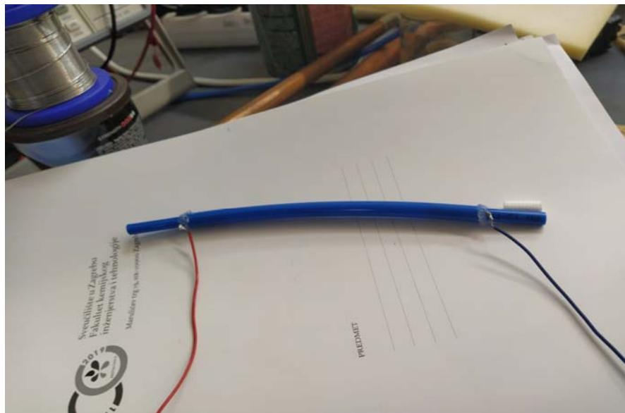
Slika 10. Primjer jednostavne izvedbe prigušnice sa NTC otporima za mjerjenje temperature
