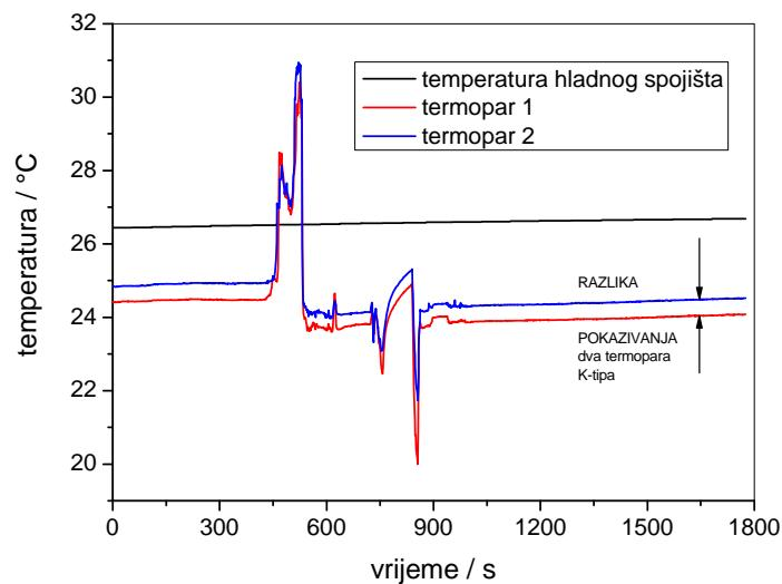
Slika 16. Baždarenje termopara
