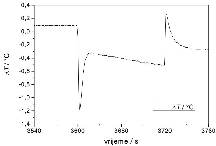
Slika 21. Promjena temperature zraka tijekom prigušenja. Nije moguće odrediti promjenu temperature jer nije postignuto stacionarno stanje (korigirana očitanja termopara).
