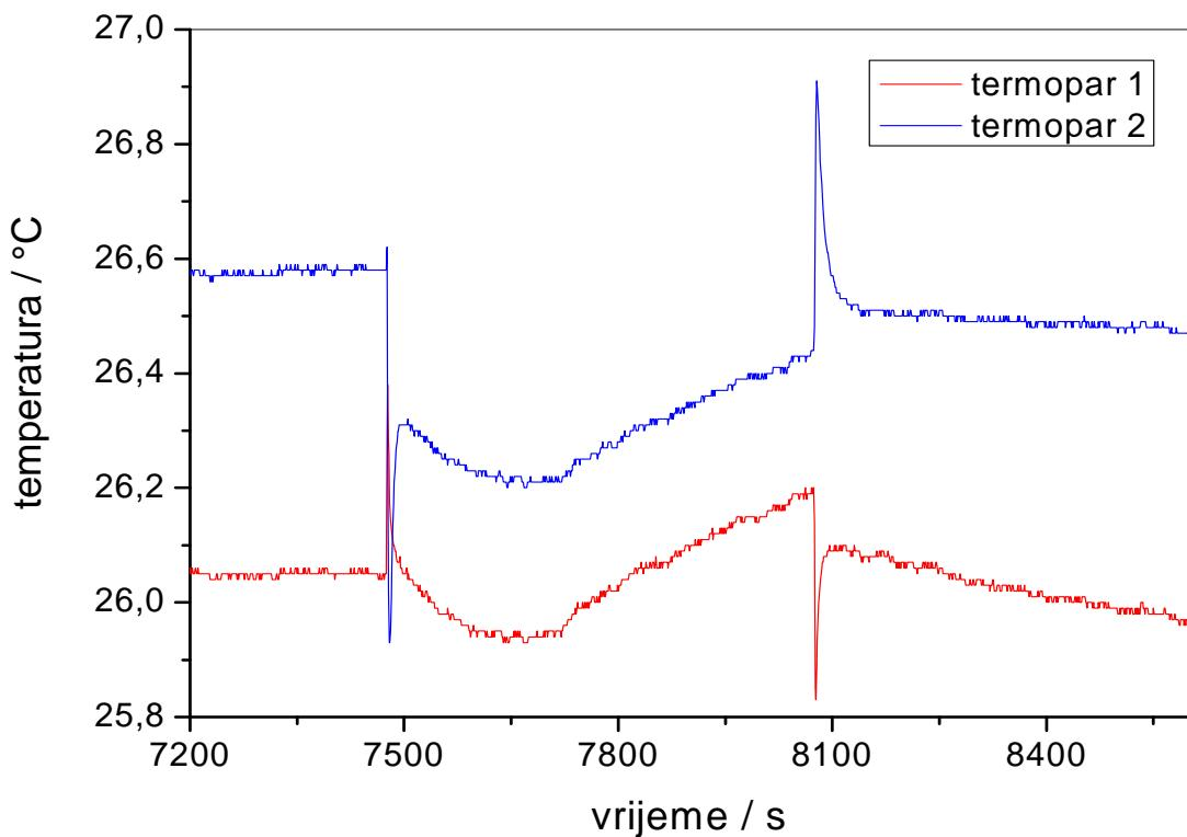
Slika 24. Rezultat mjerjenja tijekom 600 s uključenja kompresora
