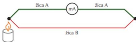
Slika 4. Shematski prikaz termopara (spoj dva *različita* metala)
