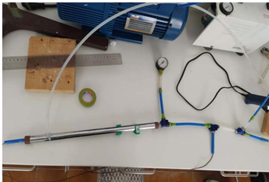
Slika 14 . i 15. Rastavljena i sastavljena aparatura za mjerjenje (termopar) sa kompresorom i vakum pumpom
