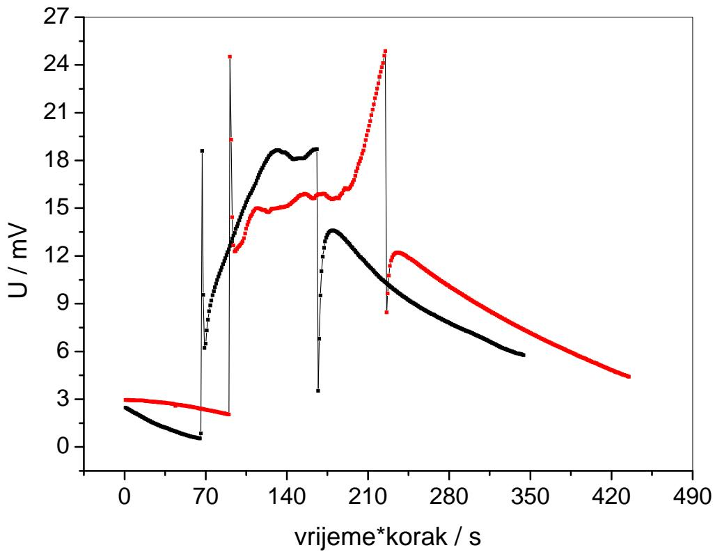
Slika 25. Mjereni napon Wheatstoneovog mosta (termistori u dvije grane mosta). Korak očitavanja napona iznosi 5 s. Prikazana su dva mjerena, no nije postignuto stacionarno stanje prigušenja komprimiranog zraka.
