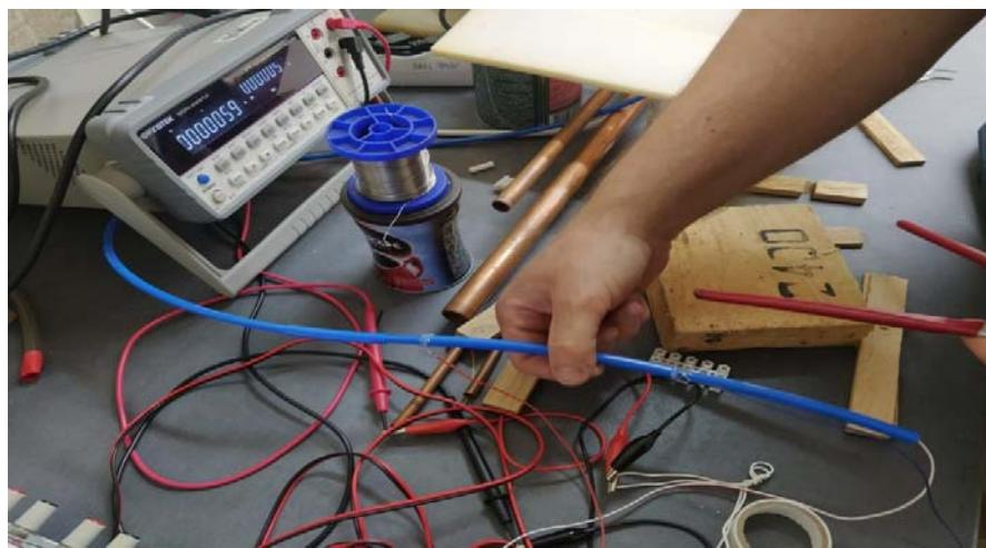
Slika 11. Aparatura za mjerjenje sa NTC otpornicima (toplinska izolacija nije prikazana).
