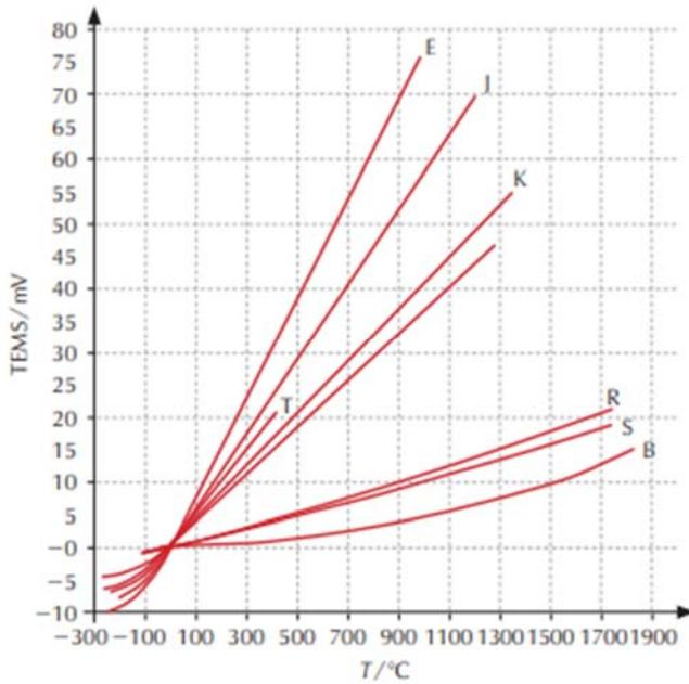
Slika 5. Temperaturno područje i naponski signal standardnih termoparova
