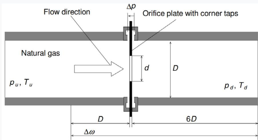
Slika 2. Shematski prikaz mjerjenja protoka u cjevovodu.
