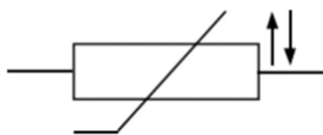
Slika 7. simbol NTC otpornika
