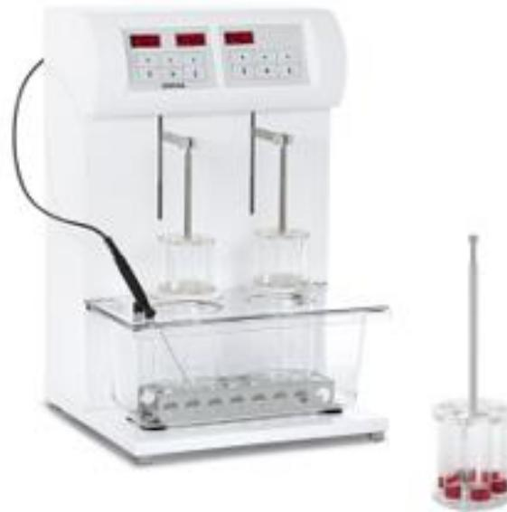
Slika 22. Fotografija uređaja za ispitivanje raspadljivosti tableta ZT 322
