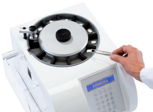
Slika 23. Fotografija uređaja za ispitivanje tvrdoće tableta (Erweka GmbH, Langen, SR Njemačka)
