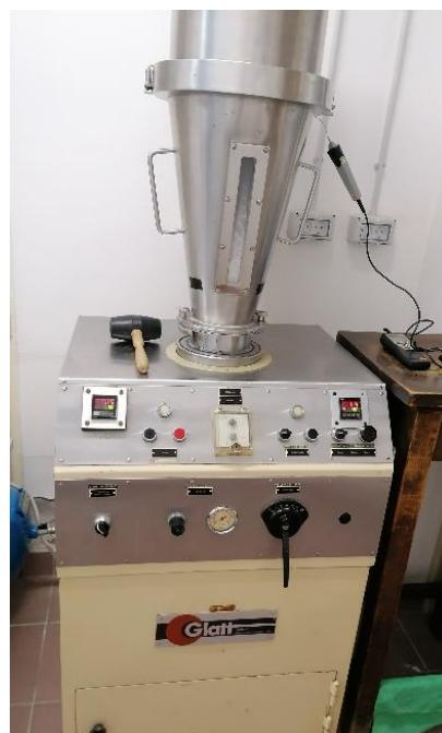
Slika 18. Fotografija granulatora s fluidiziranim slojem Uni-Glatt
