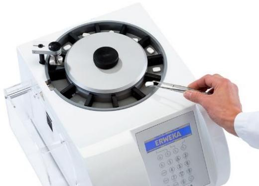
Slika 23. Fotografija uređaja za ispitivanje tvrdoće tableta
