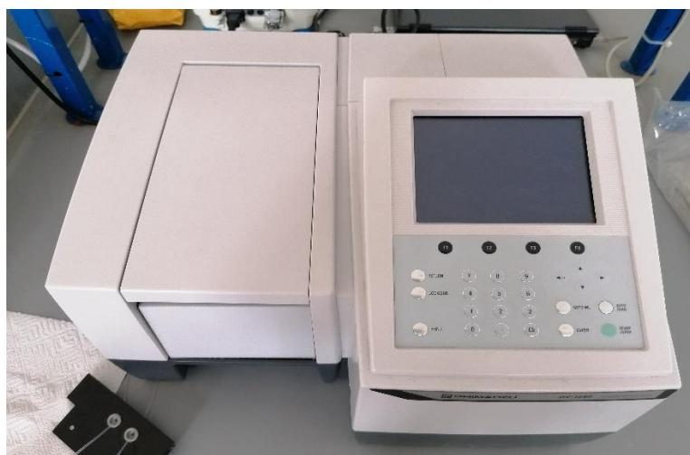
Slika 24. Fotografija UV/Vis spektrofotometra UV-1280
