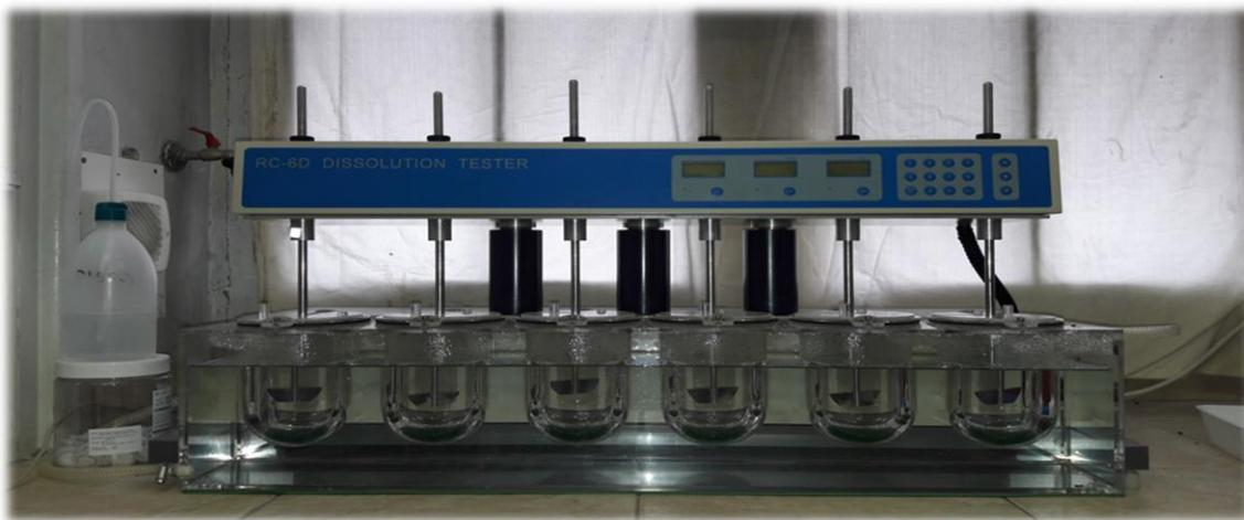
Slika 25. Fotografija uređaja za ispitivanje oslobađanja djelatne tvari RC-6D
