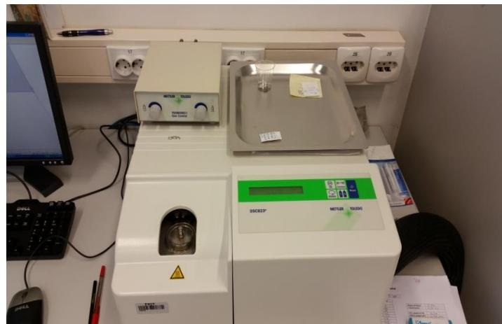
Slika 14. Fotografija diferencijalnog pretražnog kalorimetra Mettler Toledo 822<sup>e</sup>
