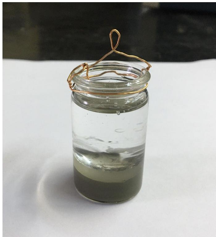
**Slika 16.** Uzorak cementne paste u bočici neposredno prije početka mjerena u većoj bočici ispunjenoj parafinom
