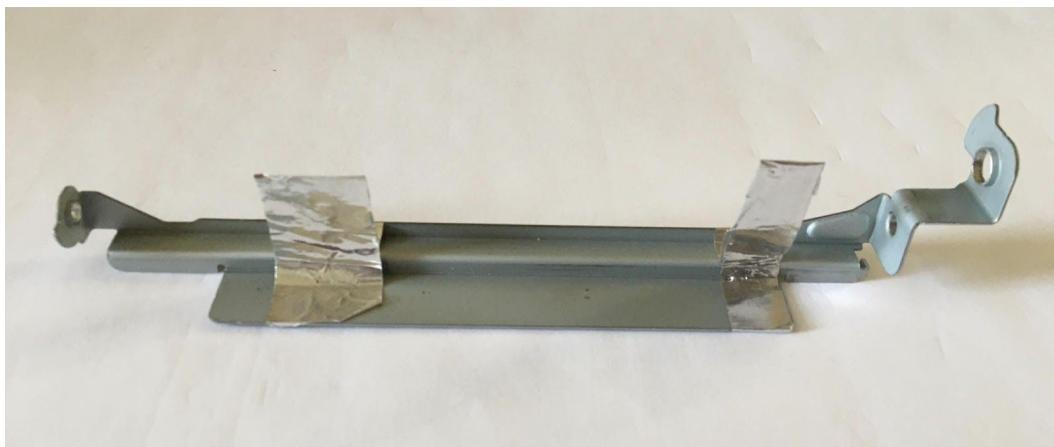
**Slika 12.** Prvi elastični element sa zastavicom, preko kojega su obavljena mjerenja uzorka A i B
