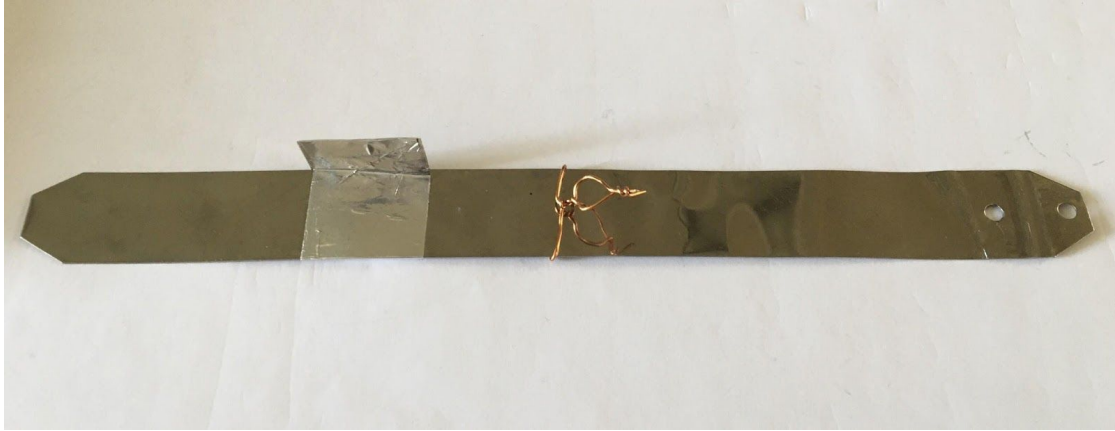
Slika 13. Drugi elastični element sa zastavicom i kukicom za uzorak, preko kojega je obavljeno mjerenje uzorka C
