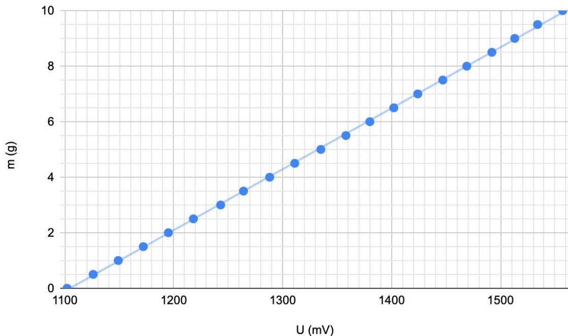
**Slika 20.** Rezultati kalibriranja fotoelektričnog senzora, vidljiva je linearna promjena napona u ovisnosti o masi utega za kalibraciju koja iznosi približno 46 mV/g
