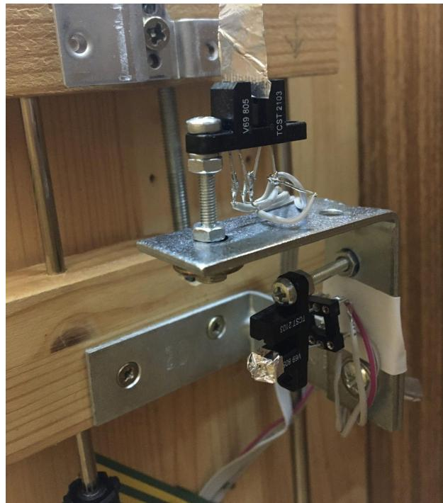
**Slika 14.** Sustav s pomičnim mehanizmom s dva TCST 2103 senzora. Iznad gornjeg senzora vidljiva je aluminijkska zastavica.
