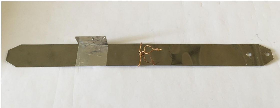
**Slika 13.** Drugi elastični element sa zastavicom i kukicom za uzorak, preko kojega je obavljeno mjerjenje uzorka C
