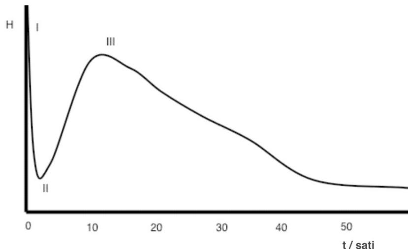
**Slika 2.** Grafički prikaz razvijanja topline tijekom vremena pri reakciji hidratacije, od trenutka dodatka vode do 60 sati nakon miješanja [4]
