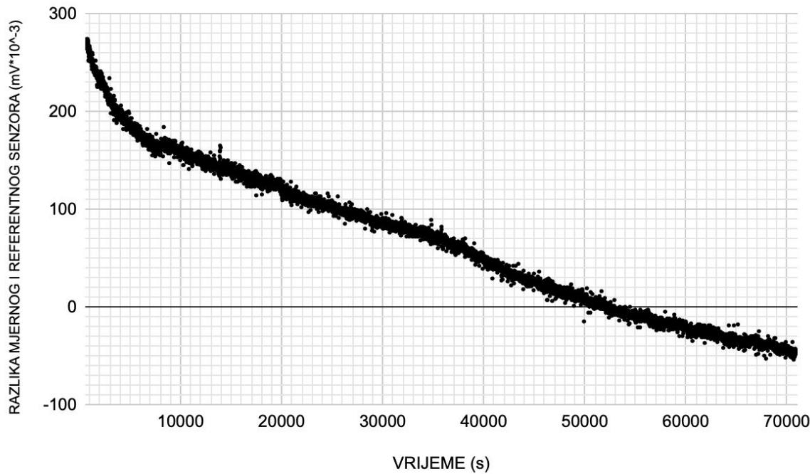
**Slika 23.** Razliku očitanog napona mjernog i referentnog senzora u svakoj točki mjerjenja za uzorak A
