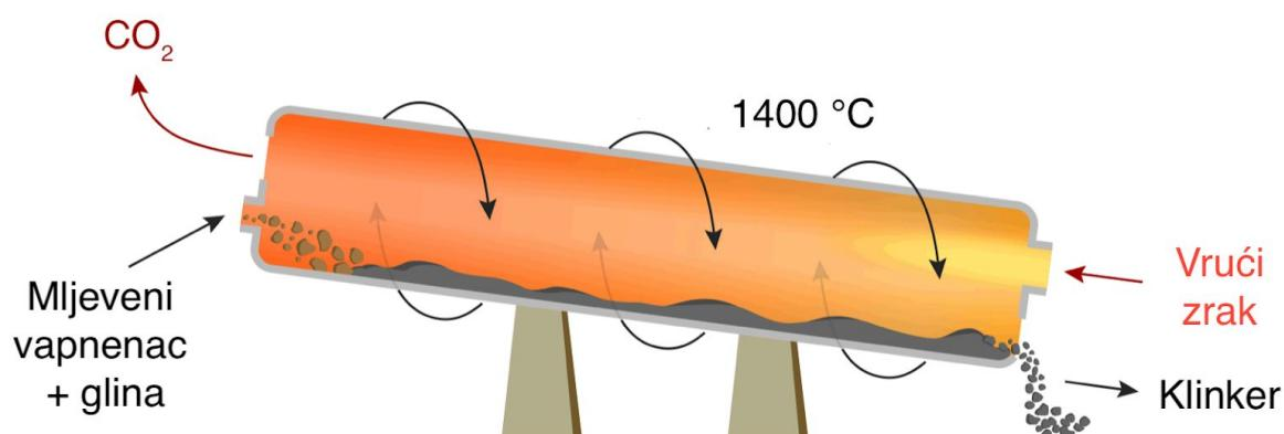
Slika 1. Ilustracija proizvodnje cementa u rotacijskoj peći [2]
