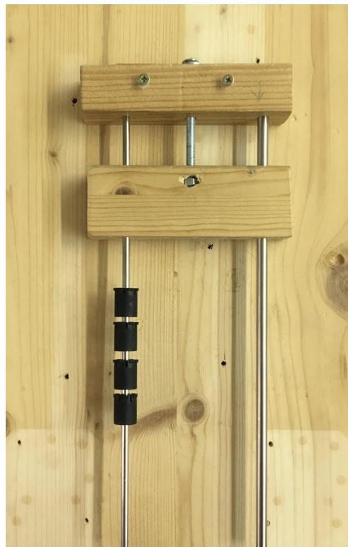
Slika 11. Mechanizam za pomicanje senzora
