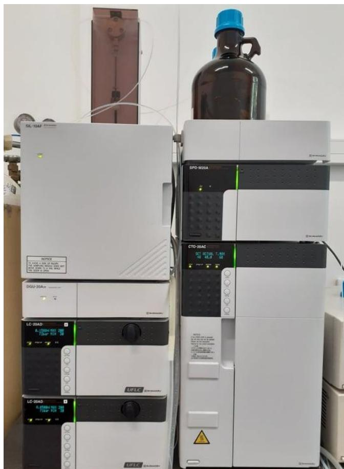
*Slika 12.* Tekućinski kromatograf HPLC-20 (Shimadzu, Japan).
