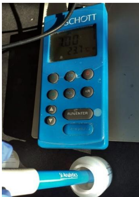
Slika 6. pH metar Handylab pH/LF 12 (Schott, Njemačka).
