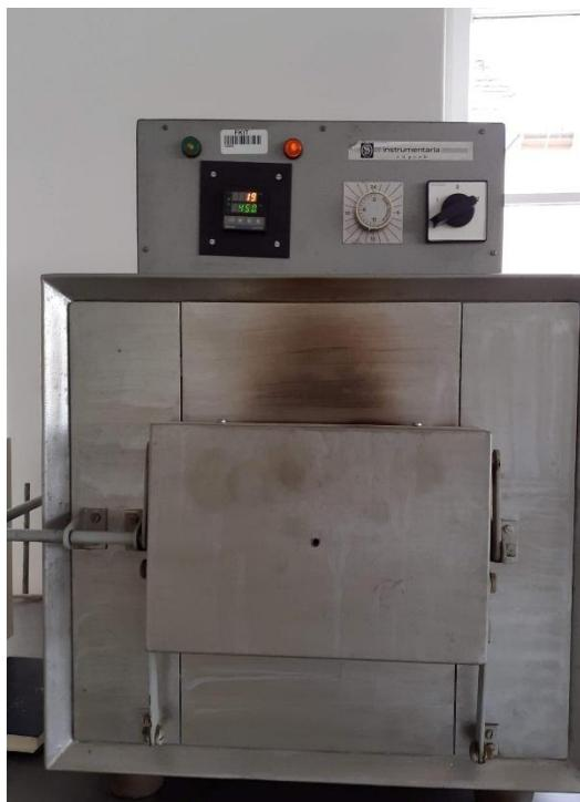
**Slika 9.** Kalciniranje u mufolnoj peći (Instrumentaria, Hrvatska).
