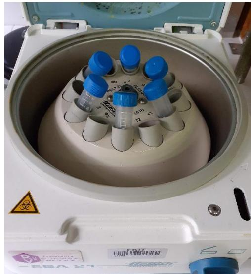
*Slika 7.* Centrifugiranje katalizatora na centrifugifi EBA 21 (Hettich, Njemačka).
