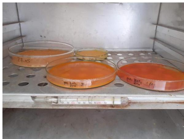
*Slika 8.* Sušenje BiVO<sub>4</sub> fotokatalizatora sintetiziranih metodom precipitacije.
