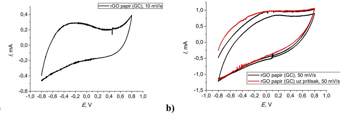
**Slika 4.9.** Ciklički voltamogram rGO papira pri brzini promjene potencijala a) 10 mV/s; b) 50 mV/s
