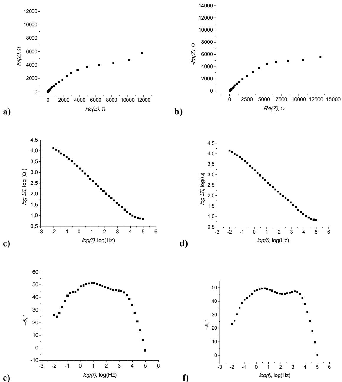
**Slika 4.24.** Nyquistov dijagram **a)** prije provedenih ispitivanja, **b)** nakon provedenih ispitivanja; Bodeov dijagram ovisnosti  $\log|Z|$  o logaritmu frekvencije **c)** prije provedenih ispitivanja, **d)** nakon provedenih ispitivanja; Bodeov dijagram ovisnosti faznog kuta o logaritmu frekvencije, **e)** prije provedenih ispitivanja, **f)** nakon provedenih ispitivanja
