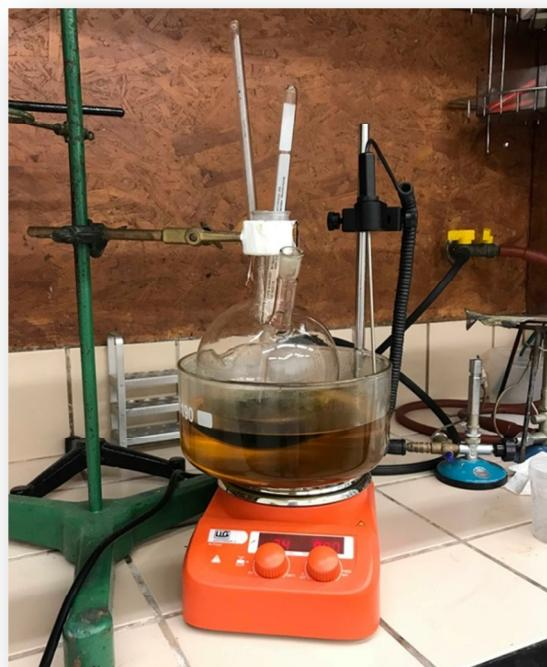
**Slika 3.2.** Aparatura za sintezu grafena Hummersovom metodom
