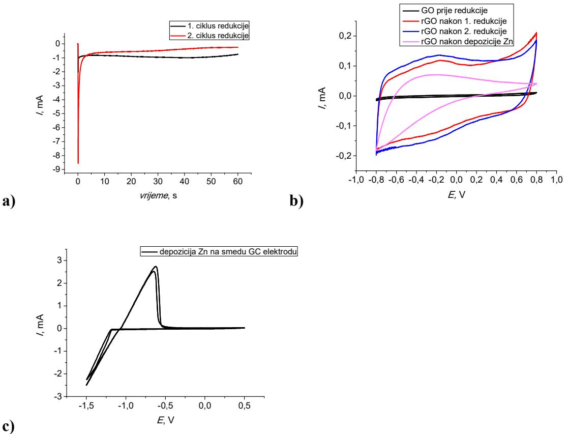
**Slika 4.3.** a) kronoamperometrijski odziv zabilježen tijekom redukcije GO sloja (tanji sloj, 10  $\mu\text{l}$ , GO sintetiziran u laboratoriju) na GC elektrodi u 0,1 M KCl pri -1,4 V; b) ciklički voltamogrami *GC/rGO elektrode*; c) depozicija Zn na *GC/rGO elektrodu* u 0,1 M  $\text{ZnSO}_4$ . Dobiveni rezultat se odnosi na GC elektrodu čiji je disk izrađen od hidrofilnog materijala (na GC formira tanji sloj rGO).
