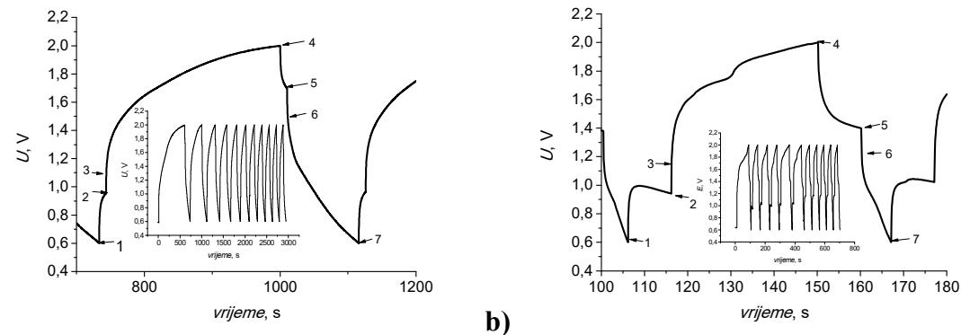
**Slika 4.18.** Krivulje punjenja/praznjenja za *Zn pločica/rGO papir* hibridni superkondenzator mjerene pri struji **a)** 0,1 mA; **b)** 0,5 mA
