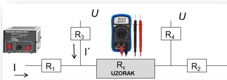
**Slika 2.20.** Ekvivalentni strujni krug kod mjerenja otpora metodom četiri točke <sup>27</sup>
