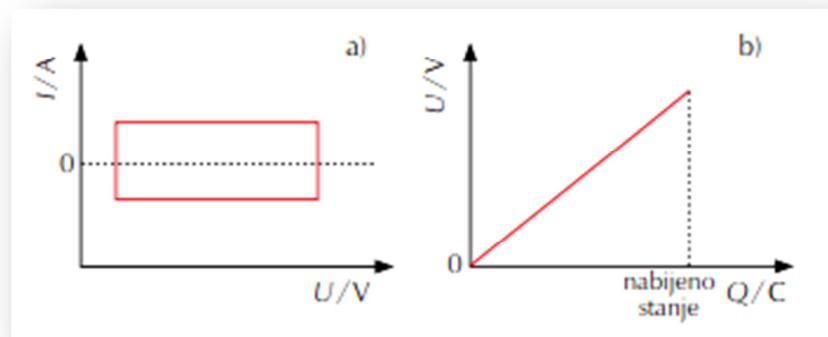
**Slika 2.11. a)** Ovisnost struje o naponu i **b)** ovisnost napona o naboju kod superkondenzatora<sup>14</sup>
