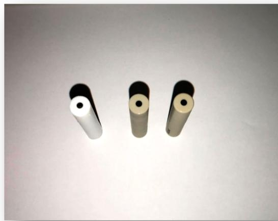
**Slika 3.12.** Disk elektrode od staklastog ugljika
