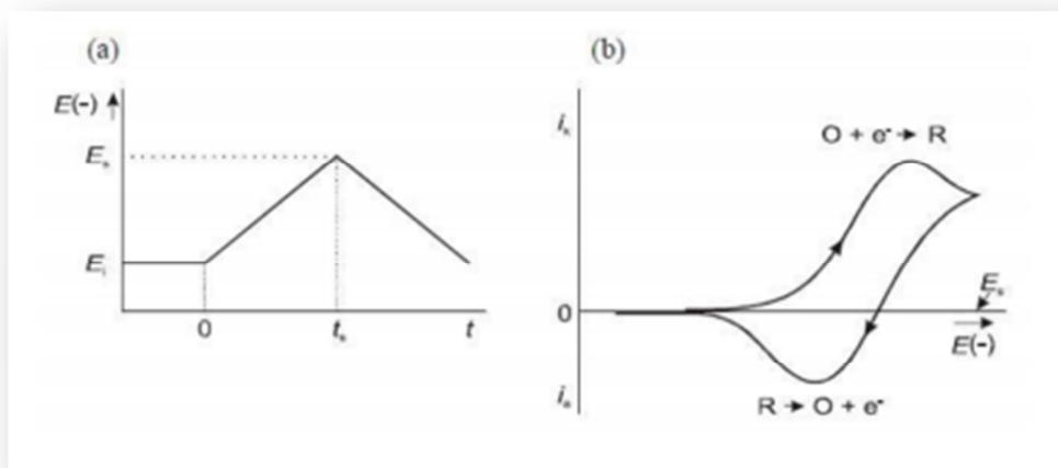
Slika 2.13. a) Signal pobude u cikličkoj voltametriji; b) signal odziva u cikličkoj voltametriji<sup>19</sup>
