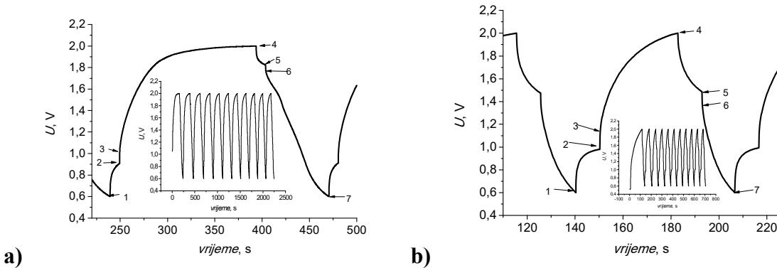
**Slika 4.25.** Krivulje punjenja/praznjenja za *rGO papir-Zn/rGO papir* hibridni superkondenzator mjerene pri struci **a)** 0,05 mA; **b)** 0,1 mA
