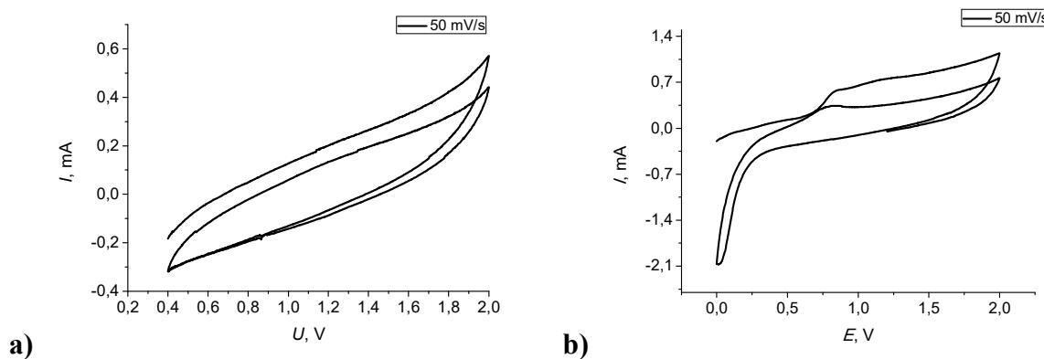
**Slika 4.15.** Ciklički voltamogrami snimljeni za *Zn pločica/rGO papir* hibridni superkondenzator u rasponu potencijala **a)** 0,4 – 2,0 V; **b)** 0 – 2,0 V
