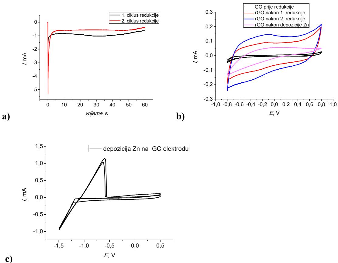
**Slika 4.2.** a) kronoamperometrijski odziv zabilježen tijekom redukcije GO sloja (deblji sloj,  $10 \mu\text{l}$ , komercijalni GO) na GC elektrodi u  $0,1 \text{ M KCl}$  pri  $-1,4 \text{ V}$ ; b) ciklički voltamogrami  $GC/rGO$  elektrode; c) depozicija Zn na  $GC/rGO$  elektrodu u  $0,1 \text{ M ZnSO}_4$ . Dobiveni rezultat se odnosi na GC elektrodu čiji je disk izrađen od hidrofobnog materijala (na GC formira deblji sloj rGO).
