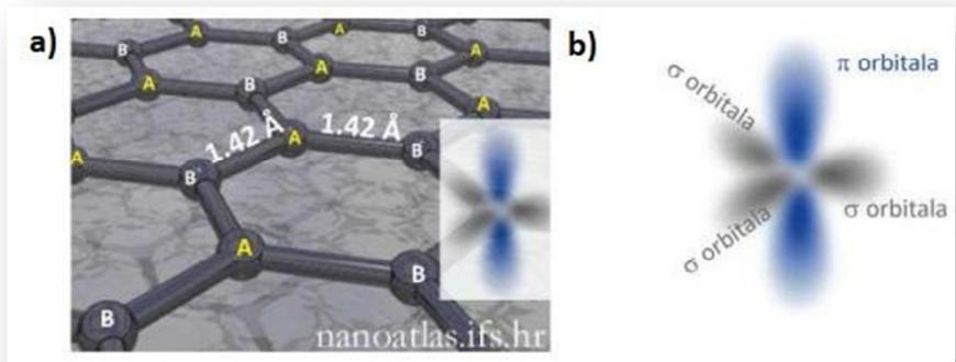
**Slika 2.3. a)** Nanometarska razina grafenske strukture i **b)**  $\sigma$  hibridne orbitale koje vežu atome u grafenu te  $\pi$  orbitala<sup>2</sup>
