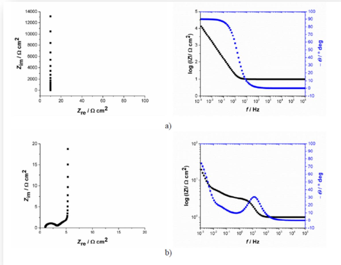
**Slika 2.17.** Nyquistov i Bodeov dijagram za jednostavne elektrokemijske sustave: a) idealni kondenzator u seriji s otpornikom, b) serijski spoj otpornika, kondenzatora i paralelne kombinacije kondenzatora i otpornika<sup>20</sup>
