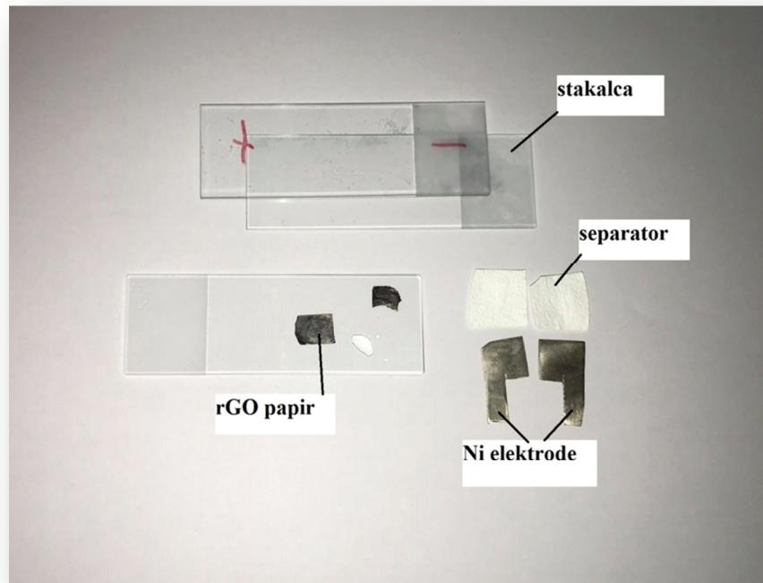
Slika 3.19. Dijelovi rGO papir-Zn/rGO papir hibridnog superkondenzatora
