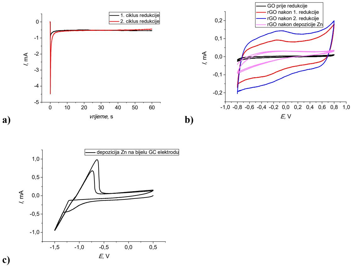
**Slika 4.4.** a) kronoamperometrijski odziv zabilježen tijekom redukcije GO sloja (deblji sloj, 10  $\mu$ l, GO sintetiziran u laboratoriju) na GC elektrodi u 0,1 M KCl pri -1,4 V; b) ciklički voltamogrami *GC/rGO elektrode*; c) depozicija Zn na *GC/rGO elektrodu* u 0,1 M ZnSO<sub>4</sub>. Dobiveni rezultat se odnosi na GC elektrodu čiji je disk izrađen od hidrofobnog materijala (na GC formira deblji sloj rGO).
