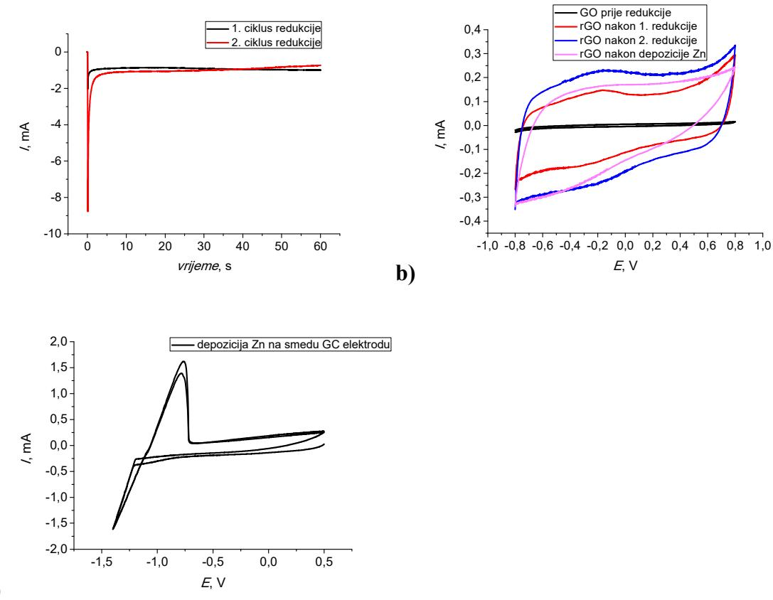
**Slika 4.5.** a) kronoamperometrijski odziv zabilježen tijekom redukcije GO sloja (tanji sloj, 20  $\mu$ l, GO sintetiziran u laboratoriju) na GC elektrodi u 0,1 M KCl pri -1,4 V; b) ciklički voltamogrami *GC/rGO elektrode*; c) depozicija Zn na *GC/rGO elektrodu* u 0,1 M ZnSO<sub>4</sub>. Dobiveni rezultat se odnosi na GC elektrodu čiji je disk izrađen od hidrofilnog materijala (na GC formira tanji sloj rGO).
