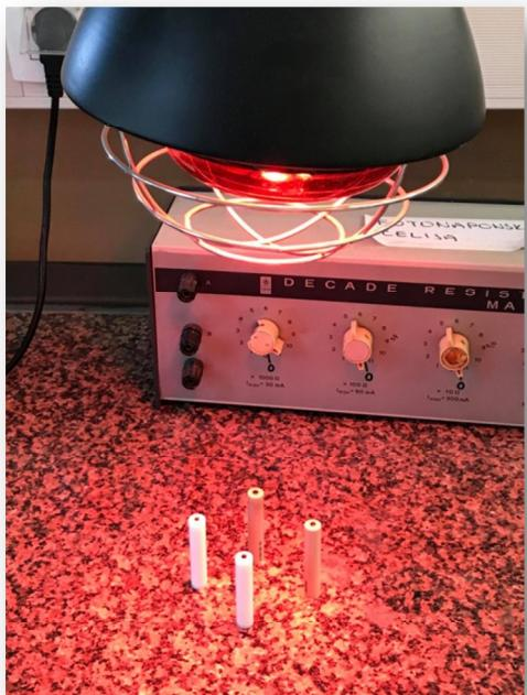
**Slika 3.13.** Sušenje GC/GO elektroda pod IR lampom
