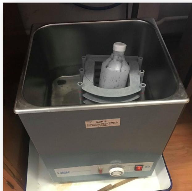
**Slika 3.5.** Ultrazvučna kupka
