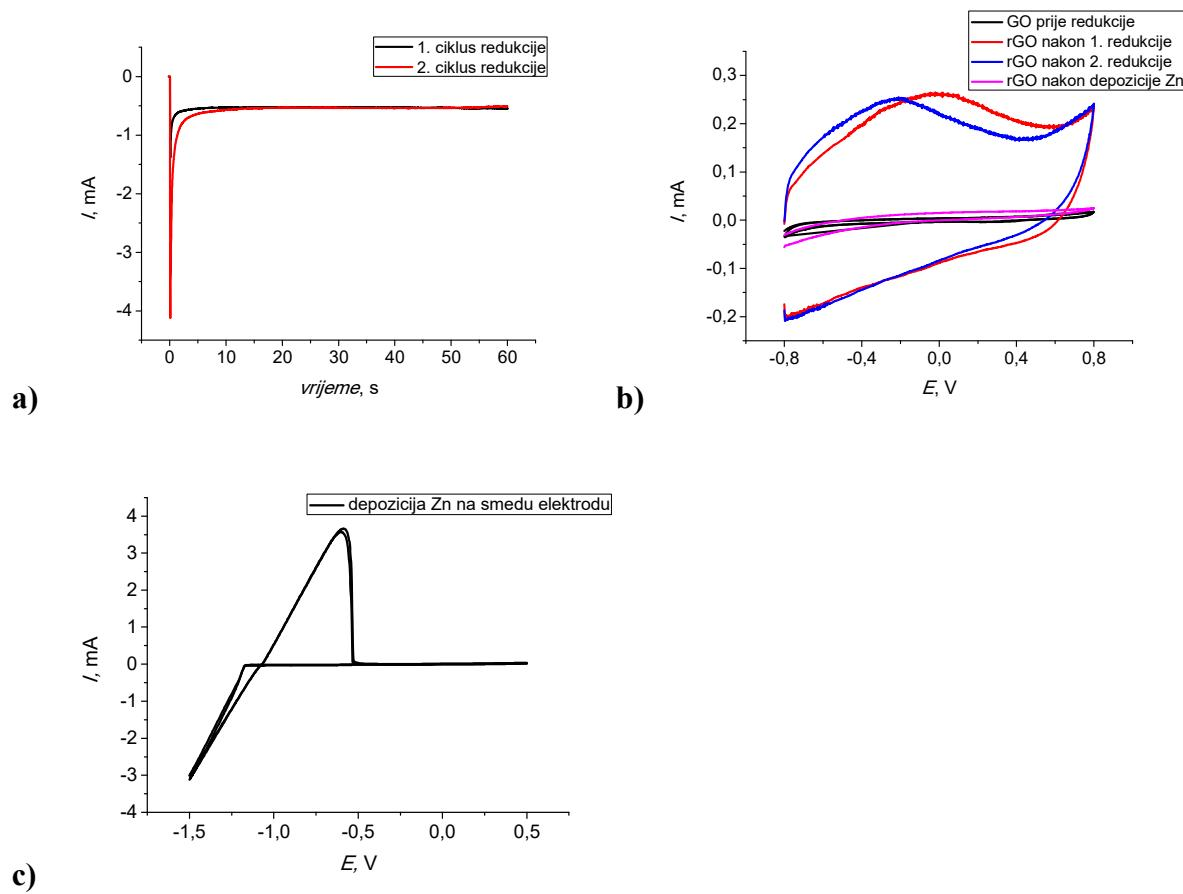
**Slika 4.1. a)** kronoamperometrijski odziv zabilježen tijekom redukcije GO sloja (tanji sloj, 10  $\mu$ m, komercijalni GO) na GC elektrodi u 0,1 M KCl pri -1,4 V; **b)** ciklički voltamogrami *GC/rGO elektrode*; **c)** depozicija Zn na *GC/rGO elektrodu* u 0,1 M  $ZnSO_4$ . Dobiveni rezultat se odnosi na GC elektrodu čiji je disk izrađen od hidrofilnog materijala (na GC formira tanji sloj rGO).
