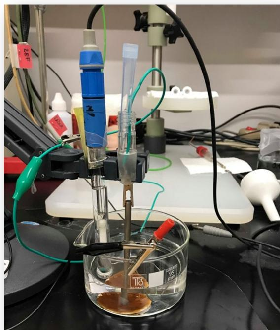
**Slika 3.8.** Troelektrodni sustav korišten za elektrokemijsku redukciju GO
