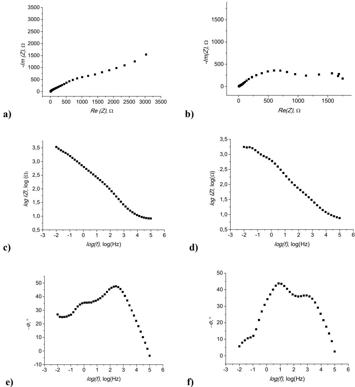
**Slika 4.16.** Nyquistov dijagram **a)** prije provedenih ispitivanja, **b)** nakon provedenih ispitivanja; Bodeov dijagram ovisnosti  $\log|Z|$  o logaritmu frekvencije **c)** prije provedenih ispitivanja, **d)** nakon provedenih ispitivanja; Bodeov dijagram ovisnosti faznog kuta o logaritmu frekvencije **e)** prije provedenih ispitivanja, **f)** nakon provedenih ispitivanja
