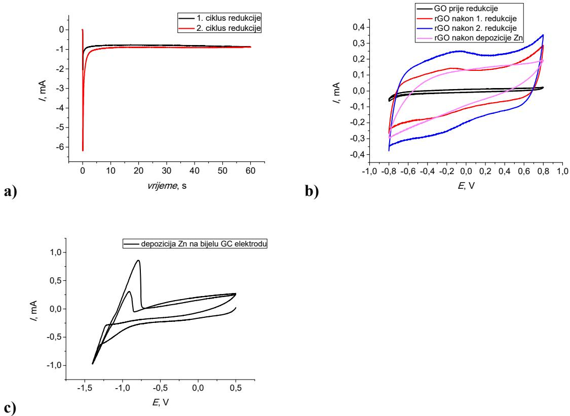
**Slika 4.6.** a) Krnoamperometrijski odziv zabilježen tijekom redukcije GO sloja (deblji sloj, 20  $\mu$ l, GO sintetiziran u laboratoriju) na GC elektrodi u 0,1 M KCl pri -1,4 V; b) ciklički voltamogrami *GC/rGO elektrode*; c) depozicija Zn na *GC/rGO elektrodu* u 0,1 M  $ZnSO_4$ . Dobiveni rezultat se odnosi na GC elektrodu čiji je disk izrađen od hidrofilnog materijala (na GC formira deblji sloj rGO).
