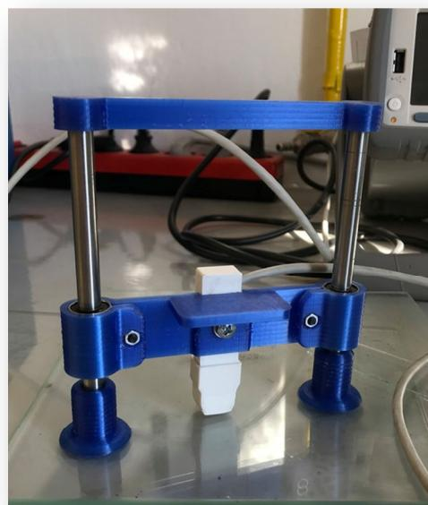
**Slika 3.10.** Uređaj za mjerjenje otpora rGO papira
