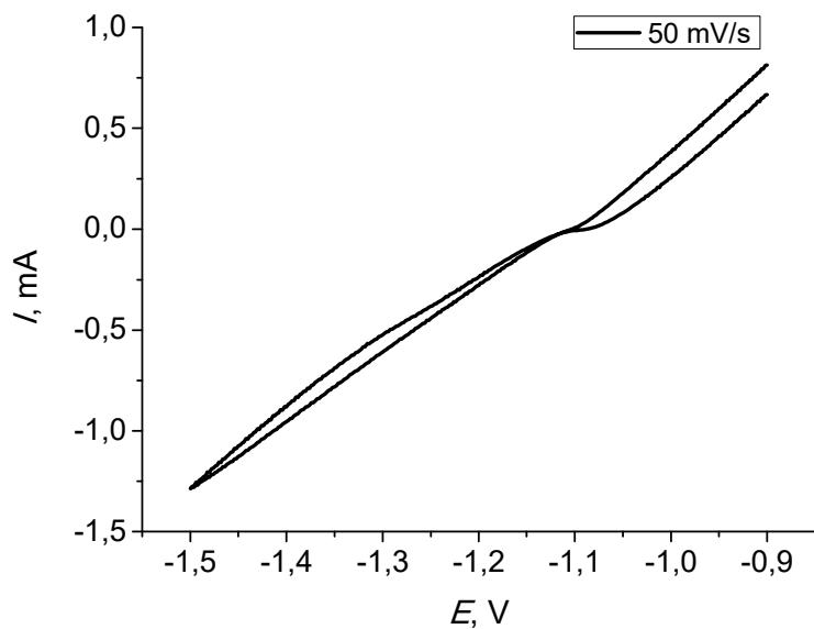
**Slika 4.12.** Polarizacija Zn pločice u troelektrodnom sustavu
