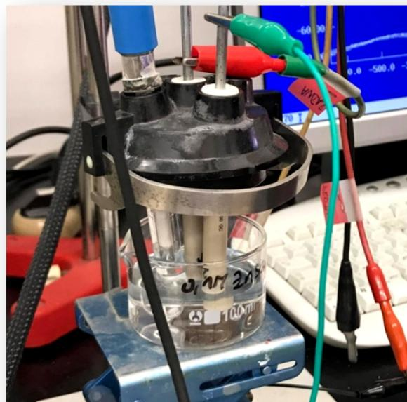
**Slika 3.18.** *Dvoelektrodni sustav s dvije GC/rGO elektrode*
