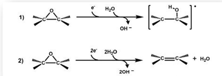
**Slika 2.7.** Mehanizam redukcije epoksidne skupine<sup>7</sup>
