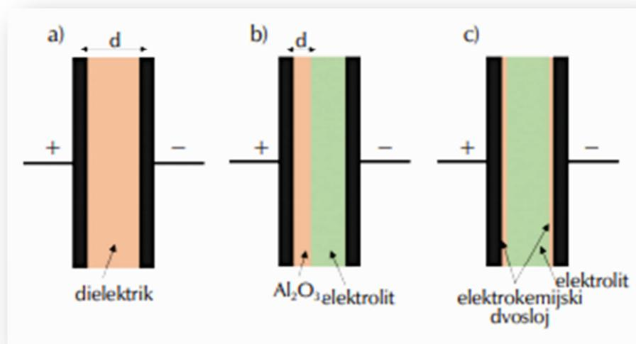
**Slika 2.10.** Shematski prikaz a) elektrostatskog, b) elektrolitskog i c) elektrokemijskog kondenzatora (superkondenzator)<sup>14</sup>
