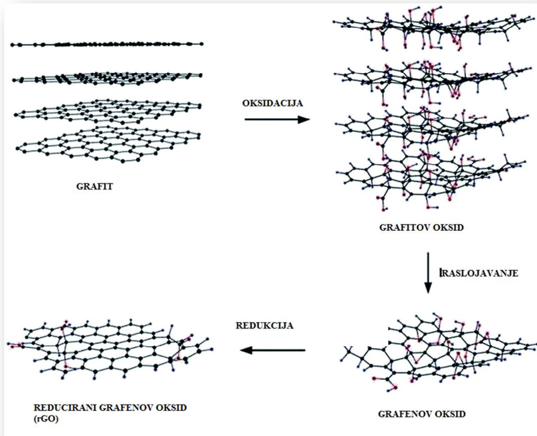
Slika 2.4. Shematski prikaz dobivanja grafena iz grafita<sup>10</sup>
