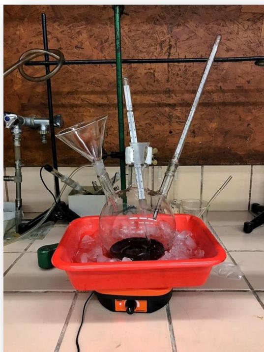
**Slika 3.1.** Aparatura za sintezu grafena Hummersovom metodom
