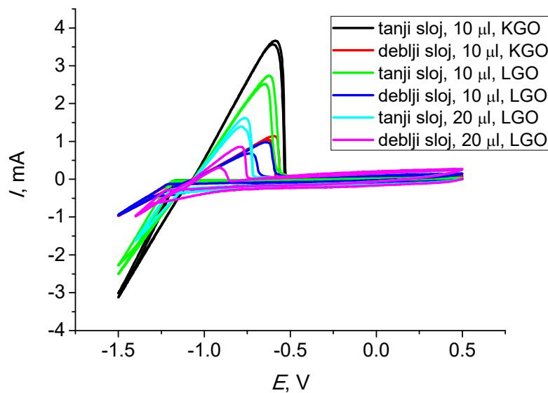
**Slika 5.2.** Krivulje depozicije Zn na *GC/rGO elektrode* u 0,1 M ZnSO<sub>4</sub> (KGO – komercijalni GO; LGO – laboratorijski sintetiziran GO)
