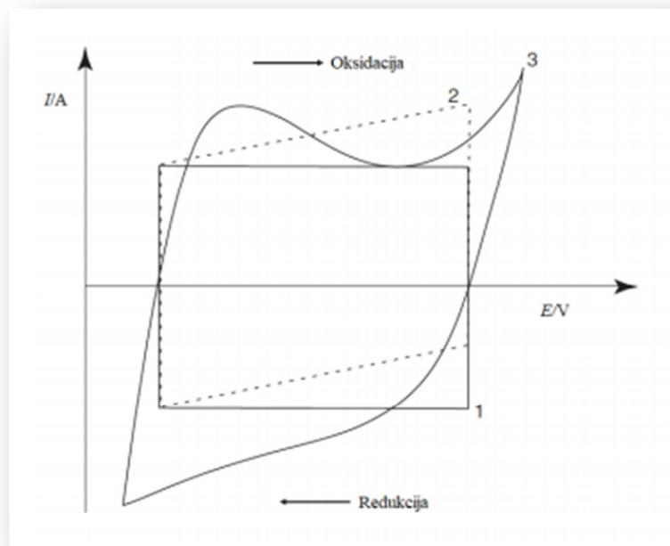
**Slika 2.14.** Ciklički voltamogram elektrode idealnog superkondenzatora (1), kondenzatora s unutarnjim otporom (2), pseudokapacitivnog materijala (3)<sup>21</sup>
