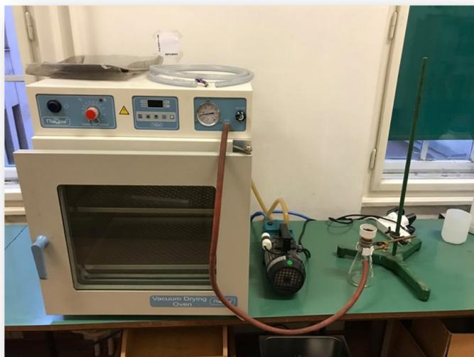
**Slika 3.7.** Aparatura za vakuum filtraciju
