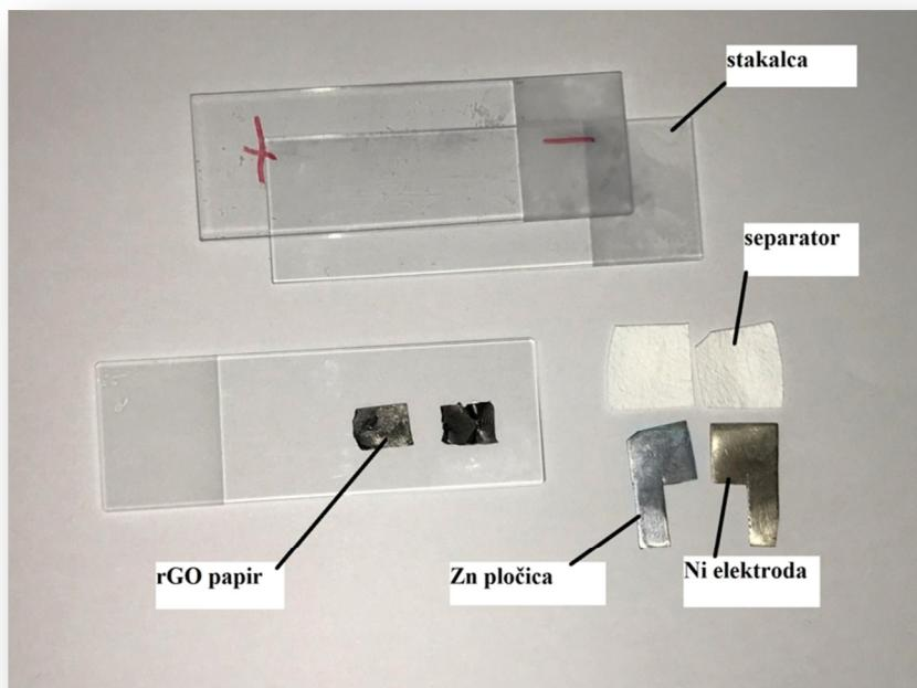
**Slika 3.16.** Dijelovi *Zn pločica/rGO papir* hibridnog superkondenzatora
