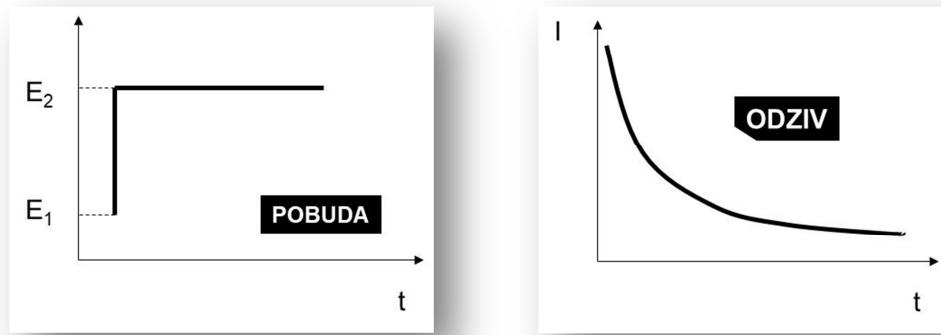
Slika 2.19. Shema dijagrama amperometrijskog mjerjenja<sup>25</sup>
