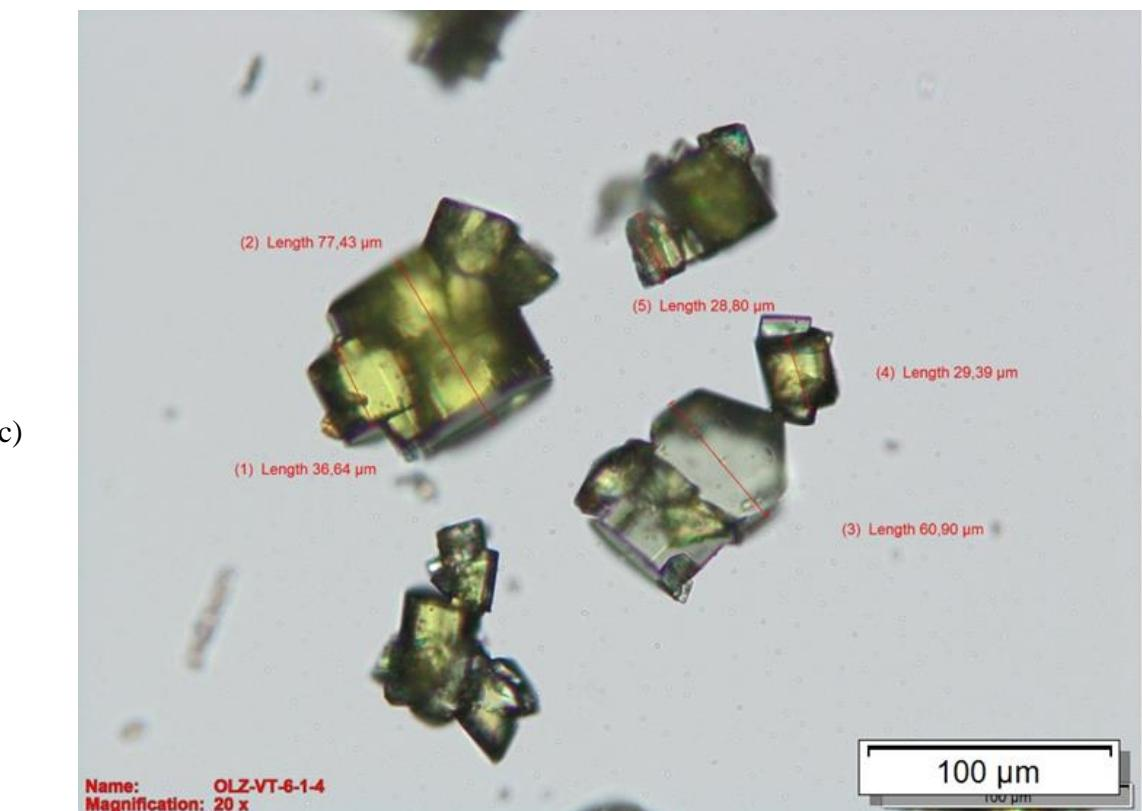
*Slika 4.22. Snimka optičkim mikroskopom pri uvećanju od a) 4x, b) 10x i c) 20x koja prikazuje kristale dobivene pri 372 okretaja u minuti miješala 3*
