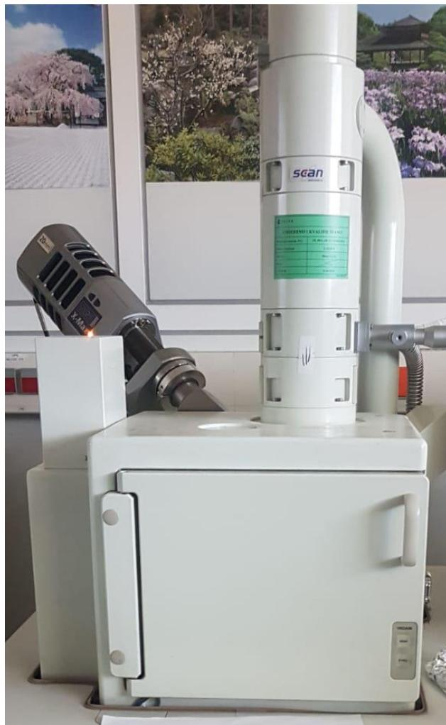
*Slika 3.7. JSM 5800 pretražni elektronski mikroskop*
