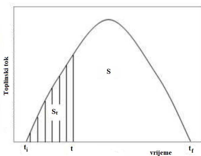
**Slika 2.12.** Izračun iskristaliziranog volumnog udjela u izotermnoj metodi
