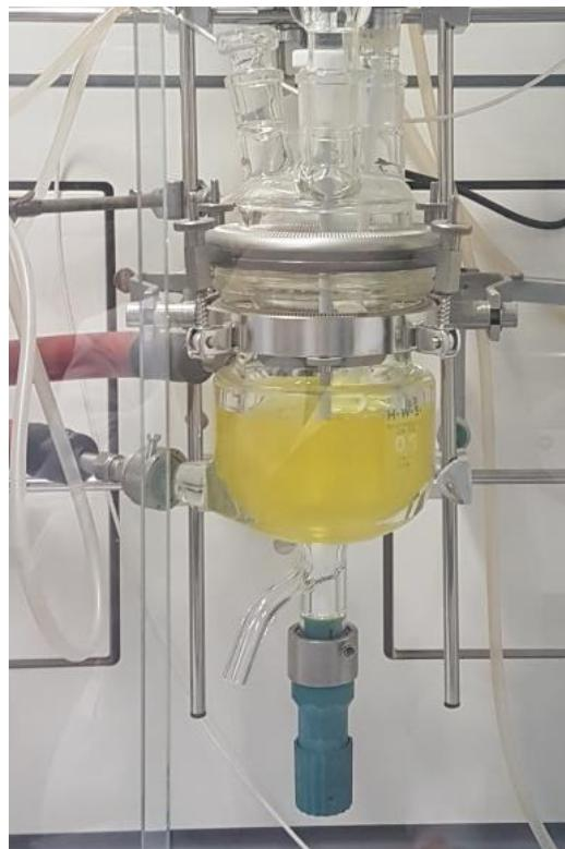
*Slika 3.2. Reaktor u kojem se određivala metastabilna zona*
