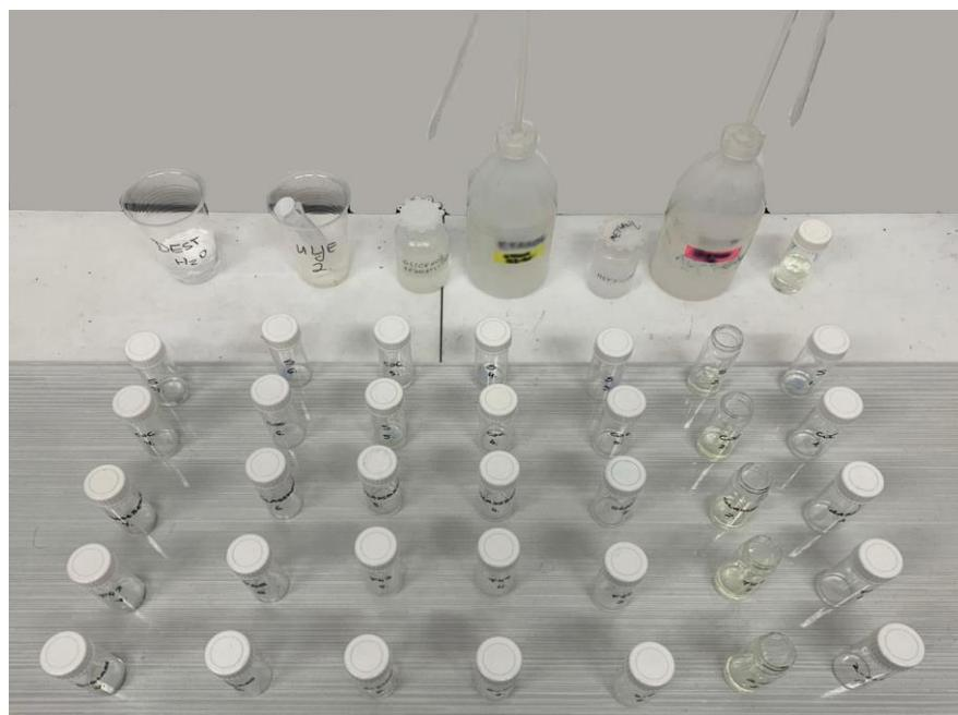
Slika 9. Ispitivanje kemijske otpornosti – test bubrenja
