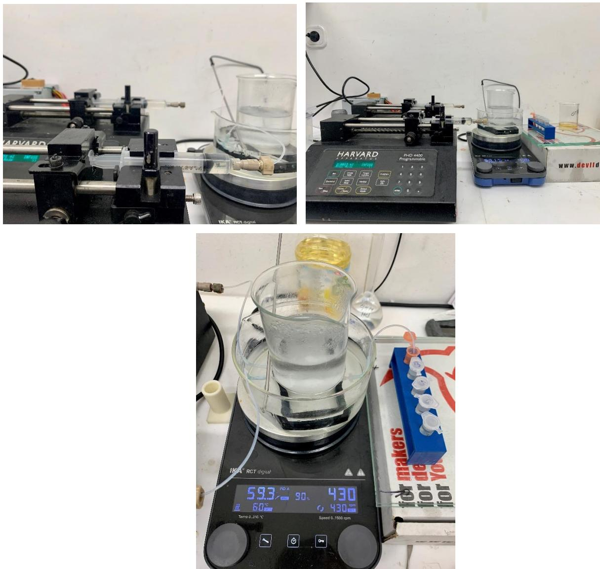
Slika 17. Aparatura za sintezu biodizela u mikroreaktoru
