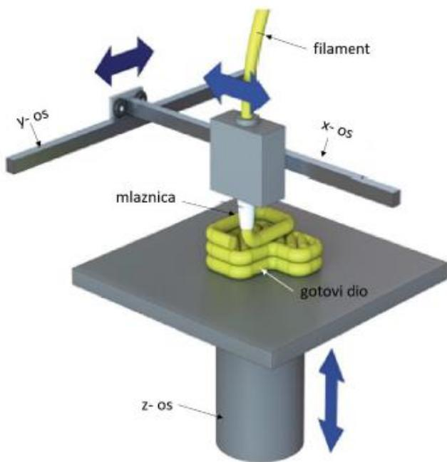
Slika 3. Postupak proizvodnje rastaljenim filamentom<sup>16</sup>
