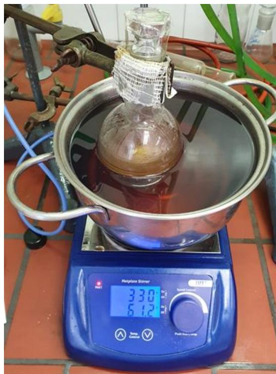
Slika 16. Sinteza biodizela u šaržnom (kotlastom) reaktoru
