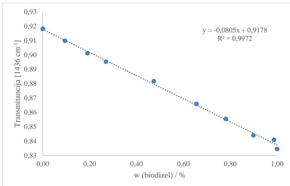
Slika 30. Baždarni dijagram ovisnosti transmitancije o udjelu biodizela za vrpcu s vrhom na  $1436 \text{ cm}^{-1}$
