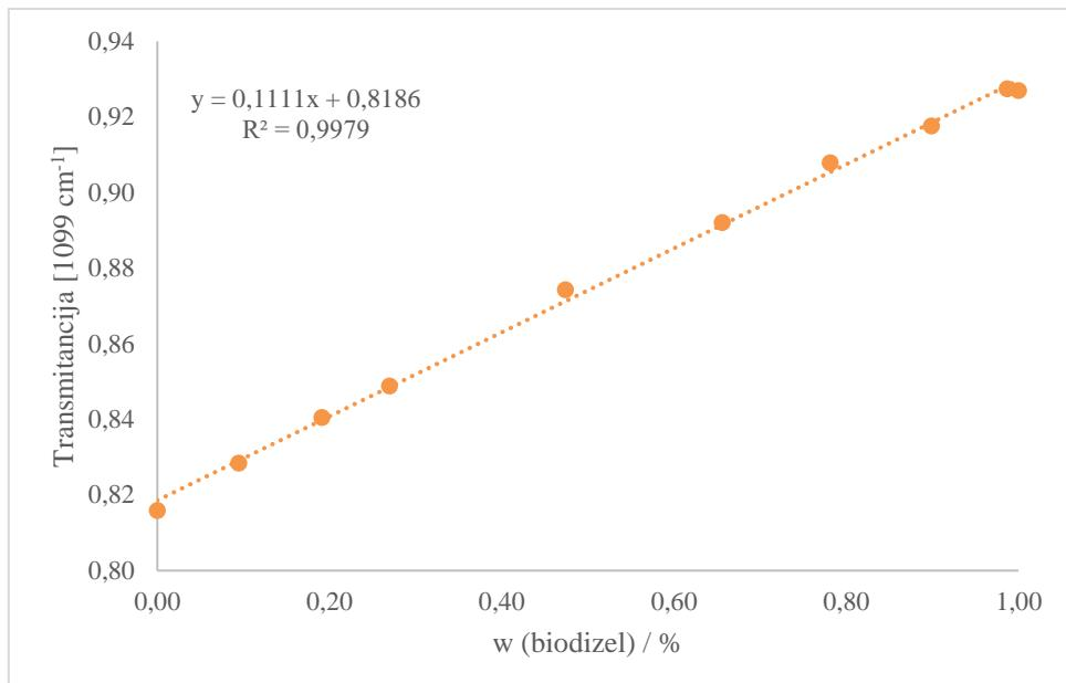
Slika 32. Baždarni dijagram ovisnosti transmitancije o udjelu biodizela za vrpcu s vrhom na  $1099 \text{ cm}^{-1}$
