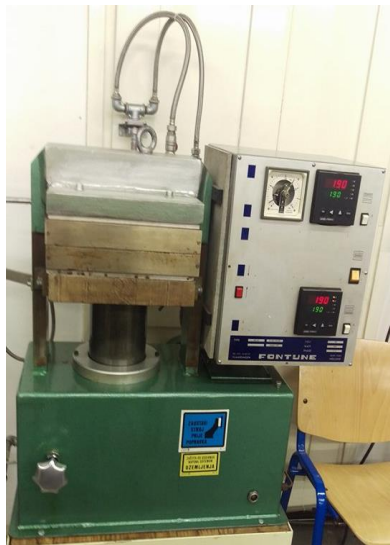
Slika 6. Hidraulička preša Fontijne
