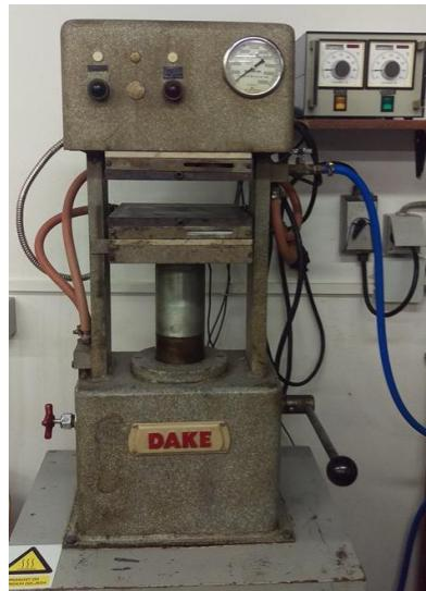
Slika 7. Hidraulička preša Dake
