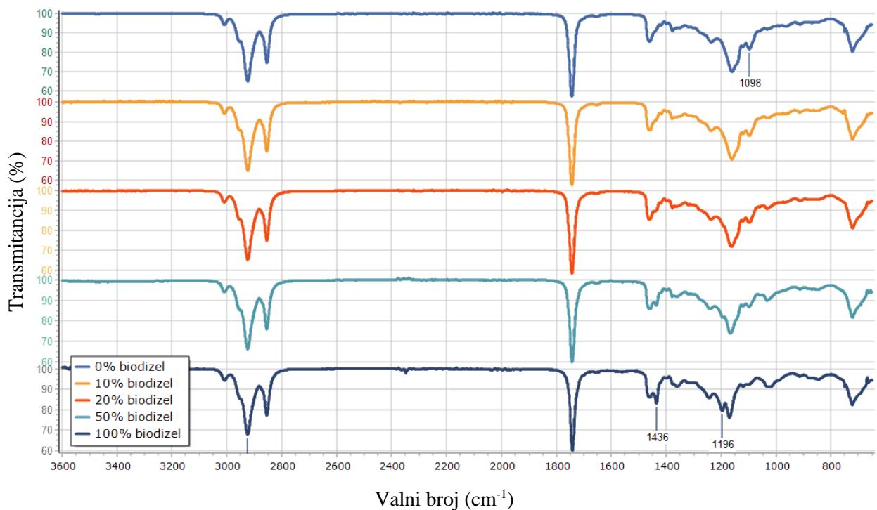
Slika 29. FTIR spektri baždarnih otopina različitih koncentracija biodizela
