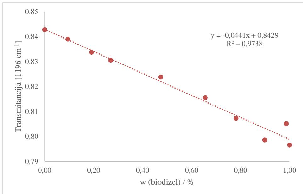
Slika 31. Baždarni dijagram ovisnosti transmitancije o udjelu biodizela za vrpcu s vrhom na  $1196 \text{ cm}^{-1}$
