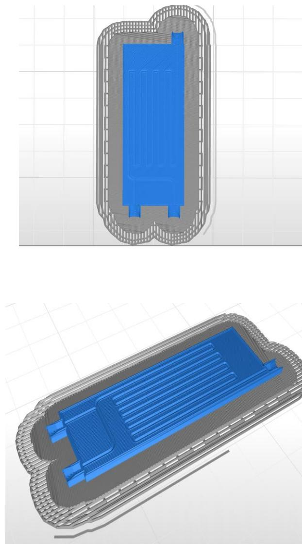
Slika 12. Mikroreaktor u računalnom programu Z-SUITE (*slicer*)
