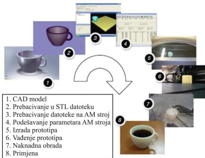
Slika 2. Postupci u proizvodnji aditivnim tehnologijama<sup>10</sup>
