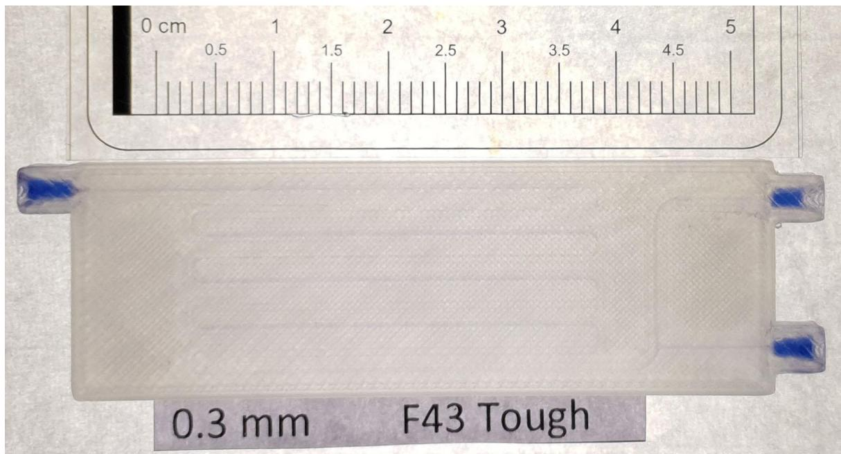
Slika 27. Primjer izrađenog modela mikroreaktora promjera mikrokanala 0,3 mm od F43
