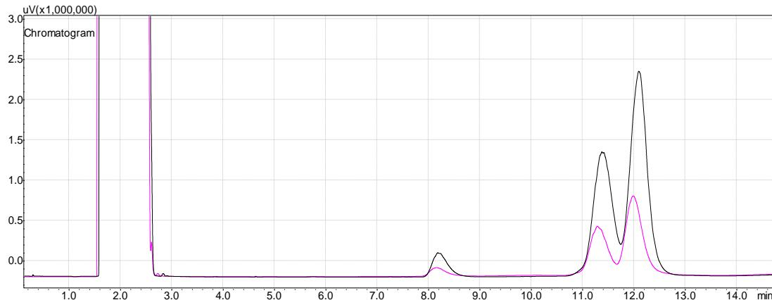
Slika 36. Kromatogram za čisti biodizel dobiven plinskom kromatografijom
