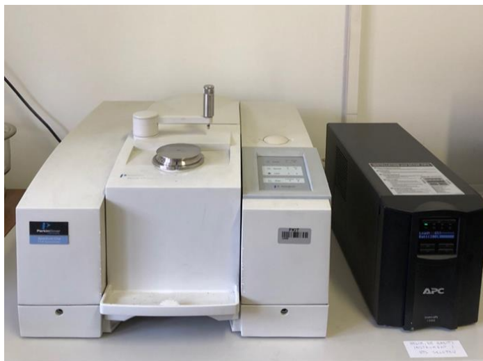
Slika 18. Perkin Elmer Spectrum One infracrveni spektrofotometar s Fourierovom transformacijom signala
