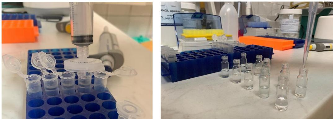
Slika 20. Priprema uzorka za GC analizu
