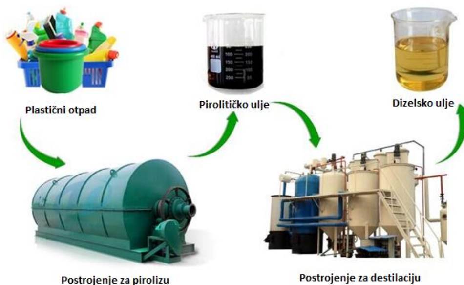
Slika 9. Proces proizvodnje dizelskog ulja iz otpadne plastike 45
