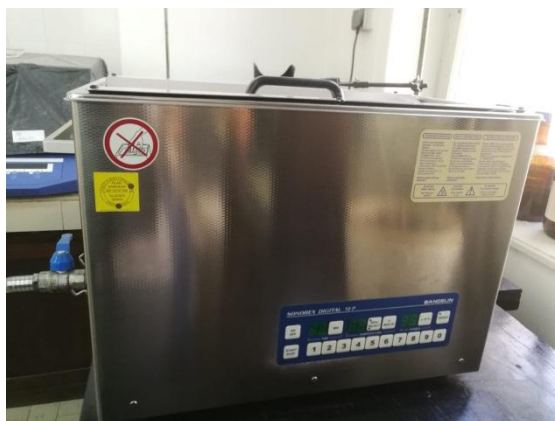
Slika 10. Ultrazvučna kupelj Bandelin Sonorex Digital 10 P
