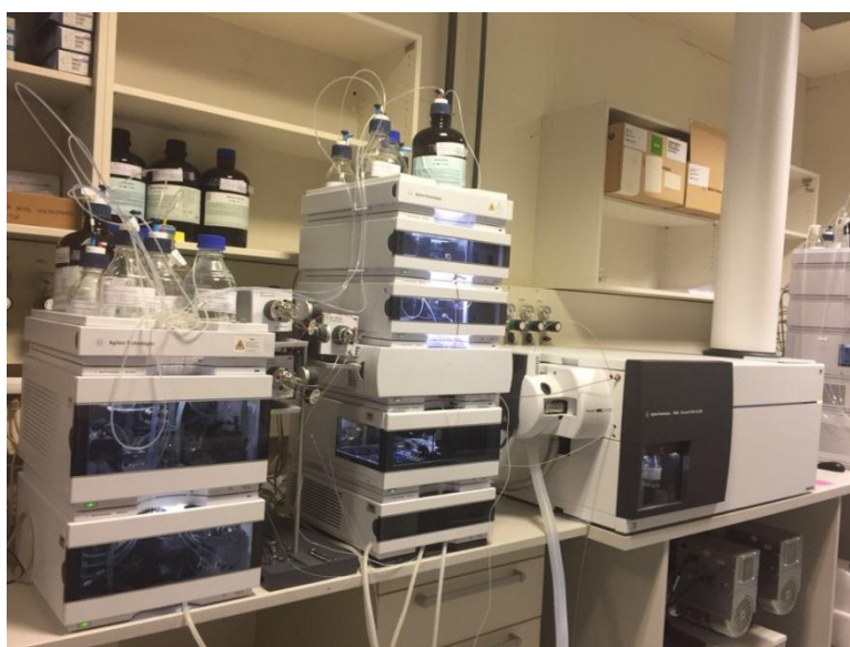
Slika 13. Tekućinski kromatograf ultravisoke djelotvornosti povezan sa spektrometrom masa visoke razlučivosti (2D-UHPLC-QTOF)
