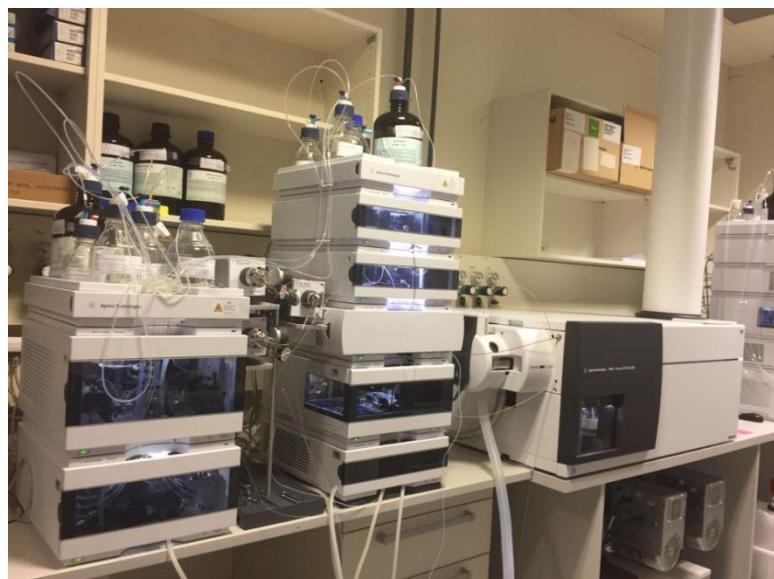
**Slika 13.** Tekućinski kromatograf ultravisoke djelotvornosti povezan sa spektrometrom masa visoke razlučivosti (2D-UHPLC-QTOF)
