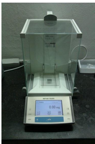
Slika 9. Analitička vaga Mettler Toledo XA105
