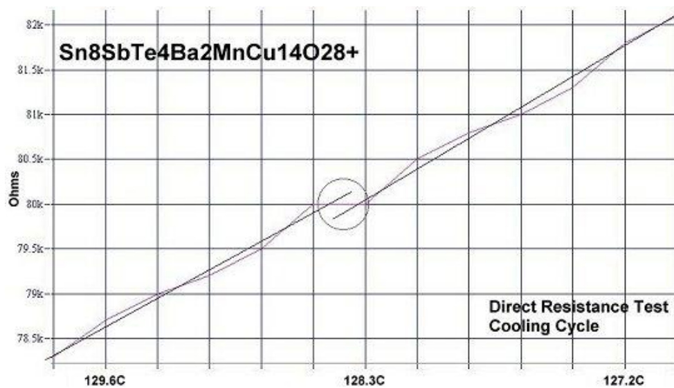
Slika 26. Grafički prikaz rezultata mjerenja otpora prilikom grijanja (gore) i hlađenja (dolje)
