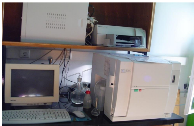
Slika 2. TOC analizator, TOC-V CPN , Shimadzu
