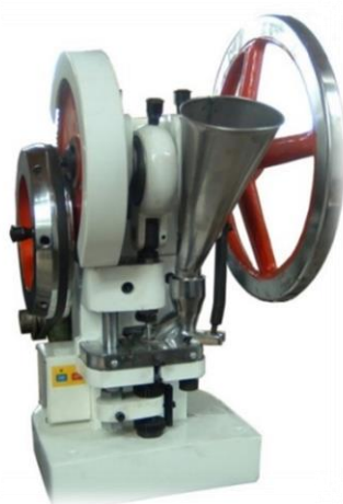
Slika 13. Fotografija uređaja za tabletiranje TDP-5T (Zhejiang Wisely Machinery Co., Ruian, NR Kina)
