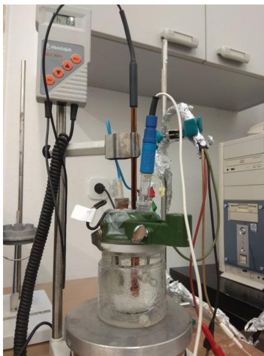
Slika 23. Aparatura za mjerenje korozivnog potencijala titana i čelika
