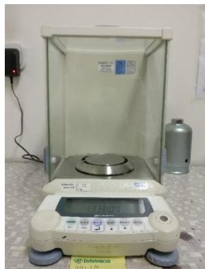
**Slika 13.** Analitička vaga *Shimadzu*
