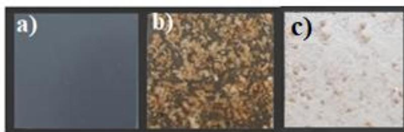
*Slika 18.* Fotografija čistog LLDPE-a (a), LLDPE/RLJ 50/50 biokompozita (b) i LLDPE/RLJ/TiO<sub>2</sub> 50/50/5 biokompozita
