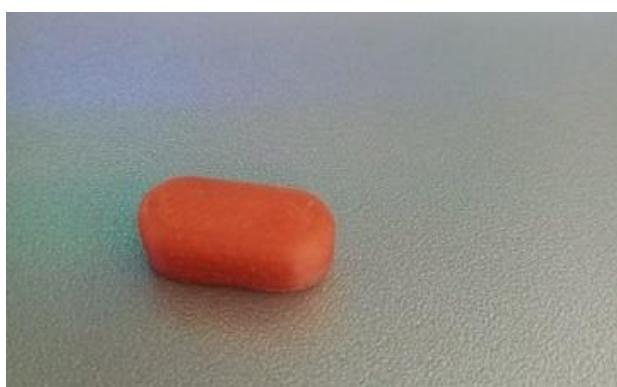
**Slika 8.** 3D tiskana tableta ovalnog oblika
