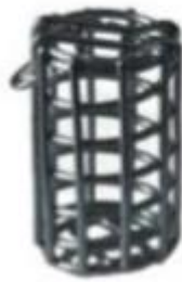
Slika 20. Košarica za potapanje kapsule; fotografija i dimenzije
