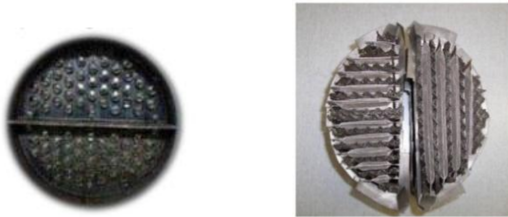
Slika 2.19. Unutrašnjost kolone s razdjelnom stijenkom:
