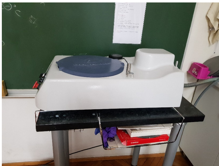
Slika 3.3. Uređaj za poliranje uzorka
