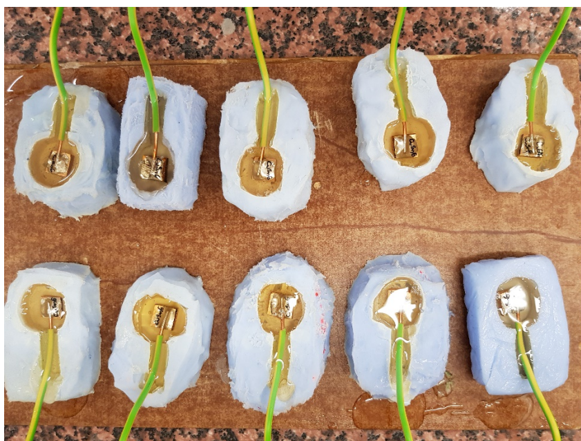
Slika 3.1. Zalijevanje radnih elektroda u epoksidnu smolu
