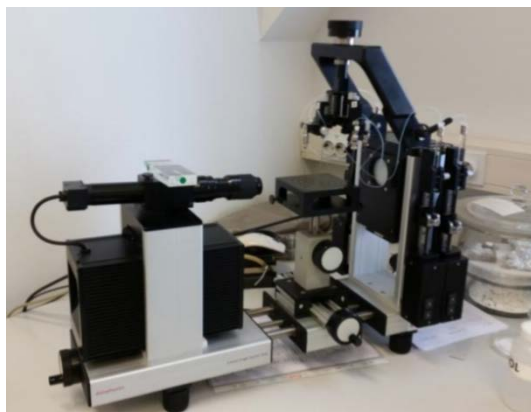
Slika 3.8. Goniometar, instrument za mjerenje kontaktnog kuta, DataPhysics OCA 20 Instrument
