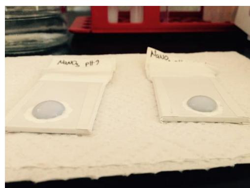
Slika 6. Elektrode s kapanim premazom na površini.
