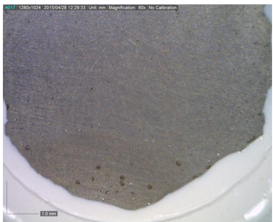
Slika 16. Jamičasta korozija na premazu AD1 pri a) sobnom i b) UV osvjetljenju.
