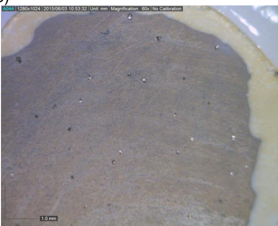
Slika 18. Jamičasta korozija na premazu NO 3 pH 2 K pri a) sobnom i b) UV osvjetljenju.
