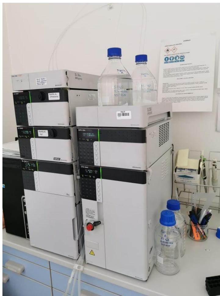
**Slika 10.** Uređaj za tekućinsku kromatografiju visoke djelotvornosti (HPLC)
