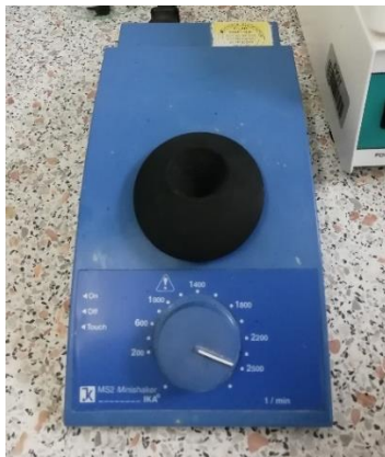
Slika 12. Homogenizator MS2 Minishaker IKA .
