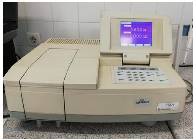
**Slika 14.** UV/VIS spektrofotometar *Shimadzu UV-1601*.
