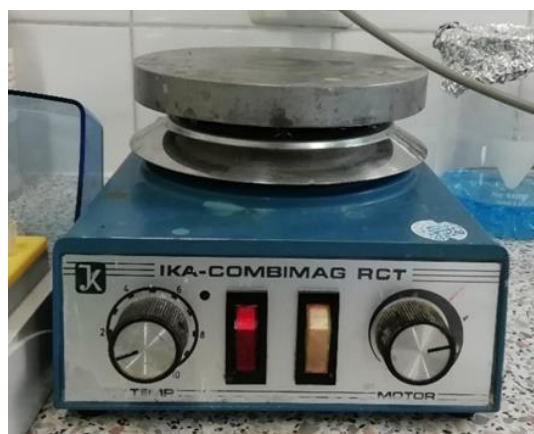
Slika 15. Magnetska miješalica s grijačem IKA – COMBIMAG RCT .
