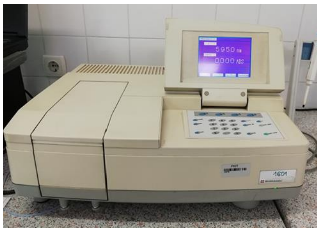
Slika 14. UV/VIS spektrofotometar Shimadzu UV-1601 .
