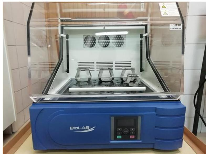
**Slika 11.** Termostatirana tresilica *BioLAB*.
