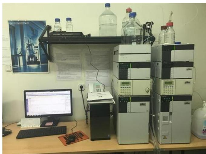
**Slika 13.** HPLC uređaj *SHIMADZU*.
