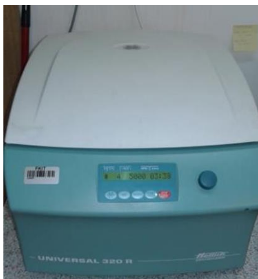
Slika 9. Centrifuga Hettich Universal 320R .
