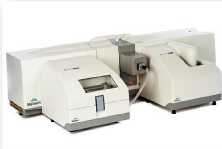
Slika 18. Uređaj za određivanje raspodjele veličina čestica Malvern .
