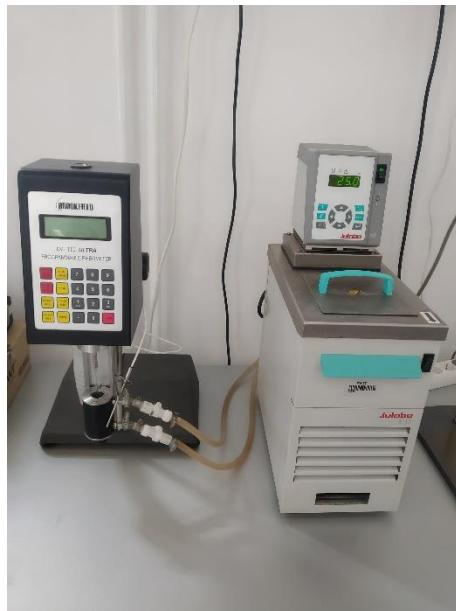
Slika 18. Uređaj za mjerjenje viskoznosti *Brookfield DV-III ULTRA Programmable Rheometer.*
