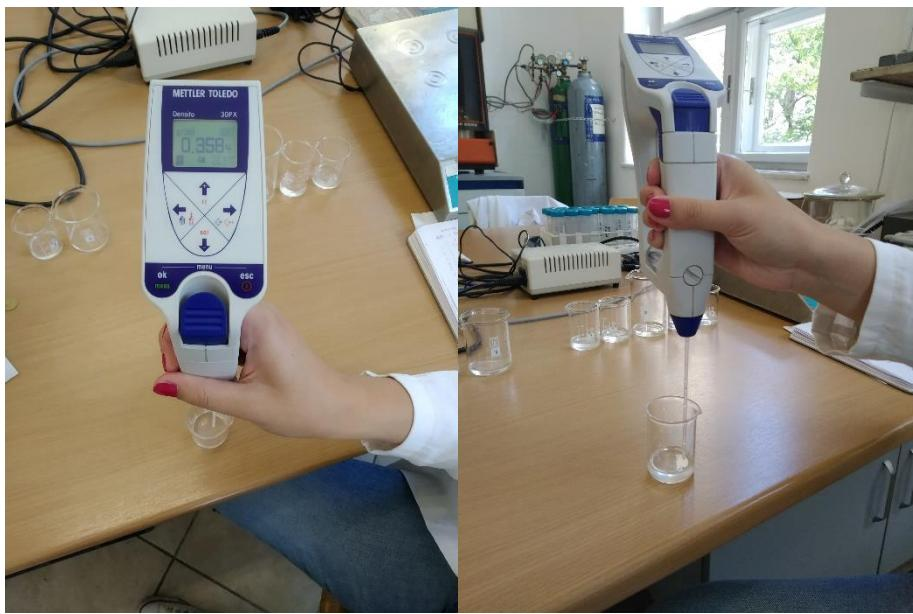
Slika 17. Uređaj za mjerjenje gustoće *Mettler Toredo Densito 30PX..*
