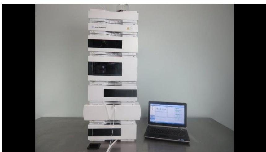
Slika 25. HPLC uređaj *Agilent 1200 series, Agilent Tehnologies, USA*.
