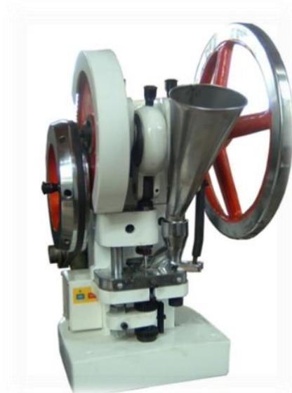
Slika 18. Fotografija uređaja za tabletiranje TDP-5T (Zhejiang Wisely Machinery Co., Ruian, NR Kina).
