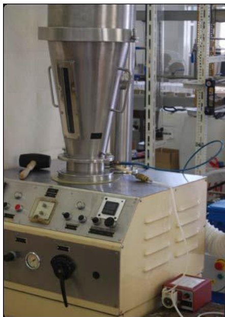
Slika 17. Fotografija granulatora s fluidiziranim slojem Uni-Glatt (Glatt GmbH, Binzen, SR Njemačka).
