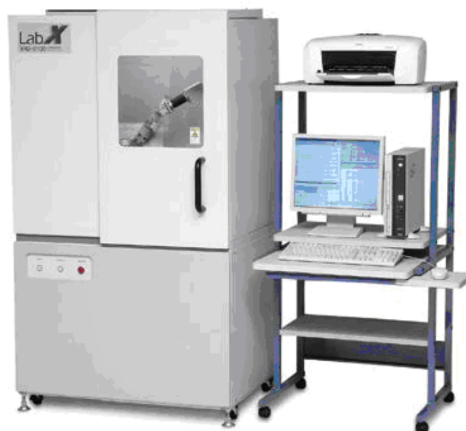
Slika 21. Fotografija uređaja za rendgensku difrakciju XRD 6000 (Shimadzu, Kyoto, Japan).
