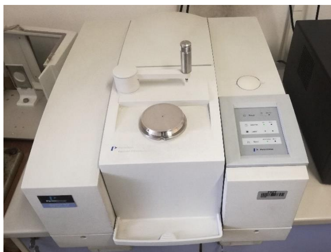
Slika 25. Infracrveni spektrofotometar s Fourierovom transformacijom signala PerkinElmer Spectrum One opremljen s ATR dodatkom
