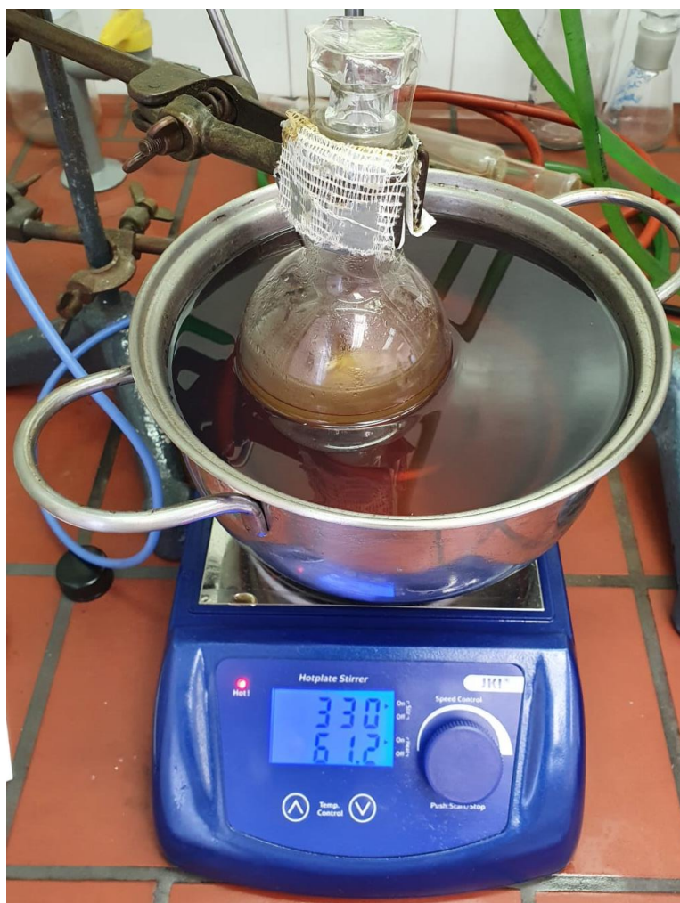
Slika 23. Šaržna reakcija biodizela
