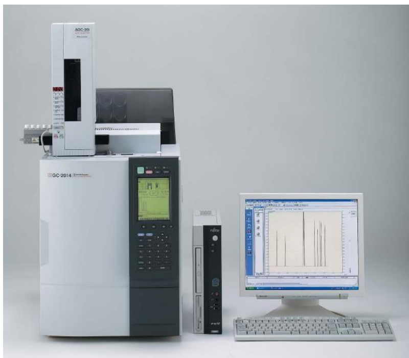
Slika 26. Plinski kromatograf (GC) Shimadzu GC-2014 s FID detektorom 34
