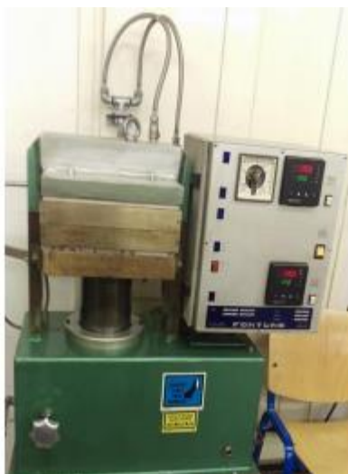
Slika 12. Hidraulička preša Fontijne
