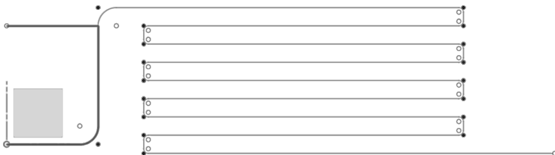
Slika 21. Prikaz reakcijskog volumena mikrokanala (svjetlo siva boja)
