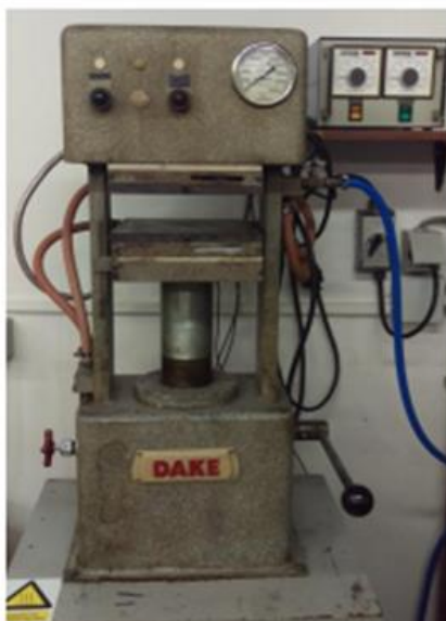
Slika 13. Hidraulička preša Dake
