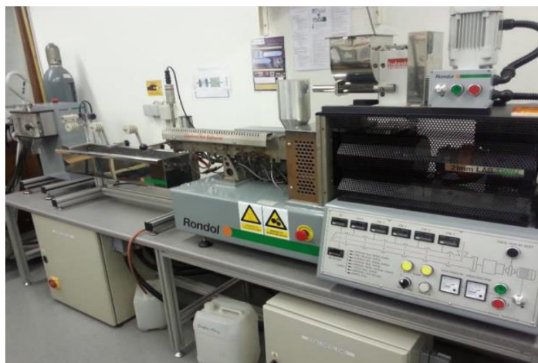
Slika 11. Rondol 21mm LAB TWIN ekstruder
