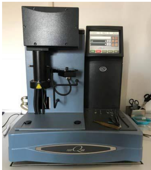
Slika 13. Termogravimetar, Q500 TA Instruments
