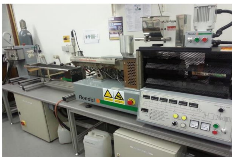
Slika 11. Rondol 21mm LAB TWIN ekstruder
