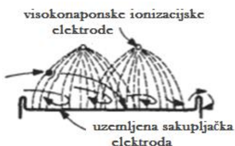
Slika 6. Kretanje čestica prema sakupljačkoj elektrodi djelovanjem električnog polja
