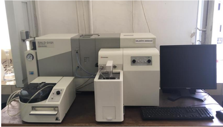
Slika 14. Uređaj za lasersko određivanje raspodjele veličina čestica SALD-3101, Shimadzu, Zavod za mehaničko i toplinsko procesno inženjerstvo, FKIT
