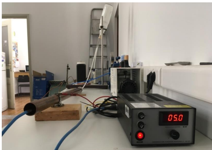
Slika 19. Dovod čestica u elektrofilter na odvajanje pri definiranom naponu
