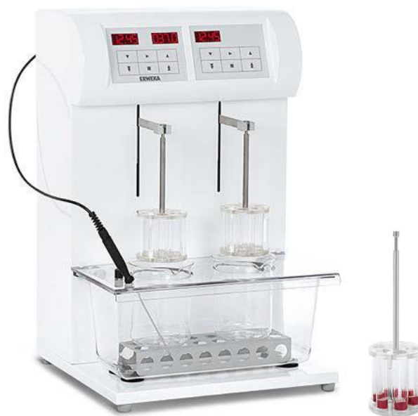
Slika 9. Uređaj za ispitivanje raspadljivosti tableta Erweka ZT 322 ( Dechra Pharmaceuticals PLC Group )
