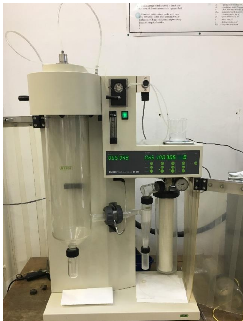
Slika 5. Laboratorijski sušionik s raspršivanjem (BÜCHI Mini Spray-Dryer B-290)
