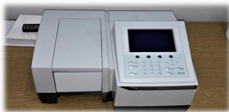
Slika 10. UV/Vis-spektrofotometar Shimadzu UV-1280
