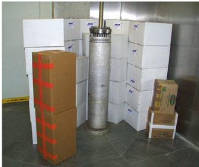
Slika 11. Izvor gama zračenja ^{60}\text{Co} u Laboratoriju za za radijacijsku kemiju i dozimetriju Instituta Ruđer Bošković
