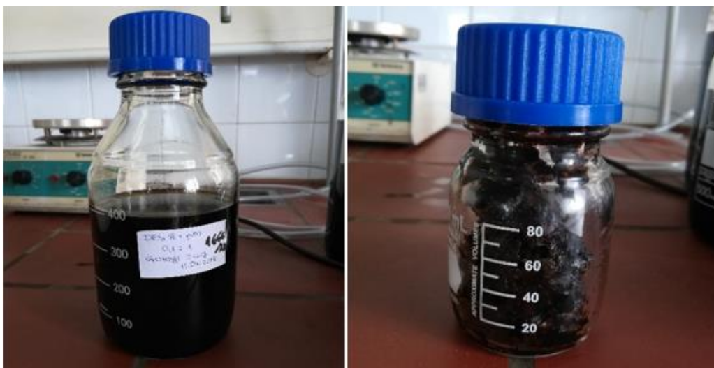
Slika 22. Gornja tekuća faza koja predstavlja pirolitičko ulje (lijevo) i donja kruta faza koja predstavlja otapalo (desno)
