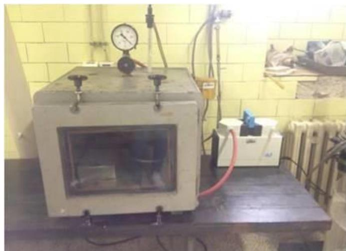
Slika 12. Vakuum sušionik
