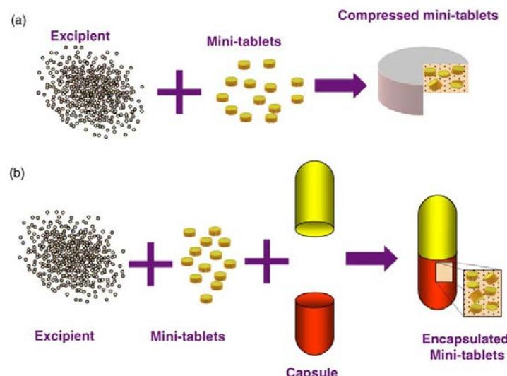
**Slika 2.8.** Minitablete proizvedene kao komprimirane minitablete (a) i kao kapsulirane minitablete (b)<sup>21</sup>
