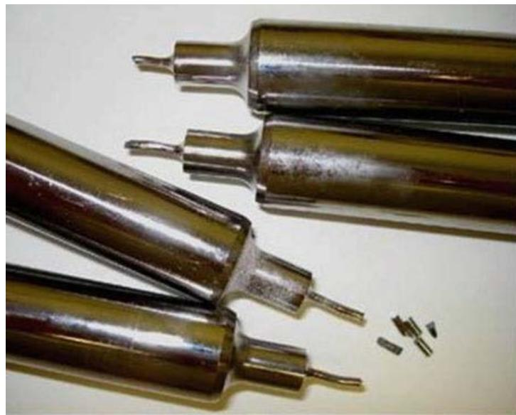
**Slika 2.7.** Primjer oštećenog alata s jednim vrhom
