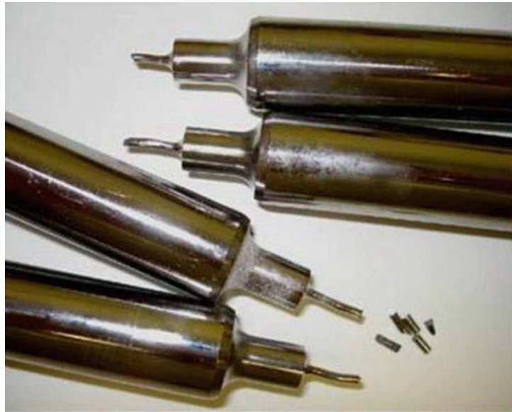
Slika 2.7. Primjer oštećenog alata s jednim vrhom nakon primjene prevelike sile kompresije
