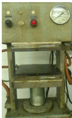
Slika 20. Hidraulička preša Dake Model 44-226
