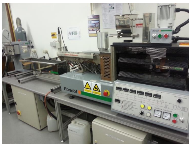
Slika 19. Rondol 21mm LAB TWIN ekstruder
