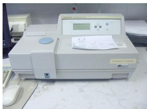
**Slika 3.5.3.** UV/VIS spektrofotometar
