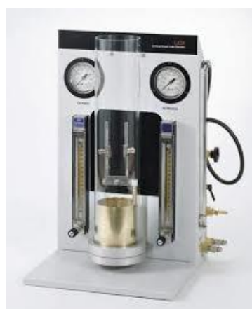
Slika 10. Uređaj za određivanje minimalne koncentracije kisika
