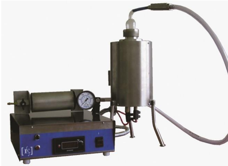
Slika 11. Uređaj za određivanje minimalne temperature paljenja prašine
