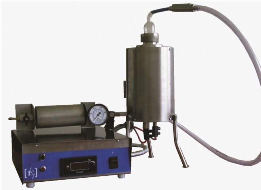
Slika 11. Uređaj za određivanje minimalne temperature paljenja prašine
