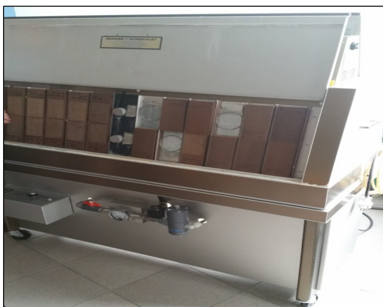
Slika 16. QUV uređaj tvrtke Q-Panel
