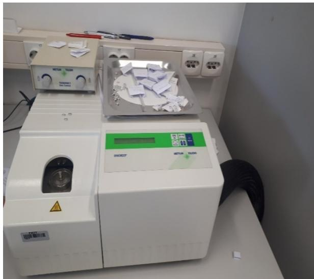
*Slika 17.*Diferencijali pretražni kalorimetar Mettler toledo DSC 823e
