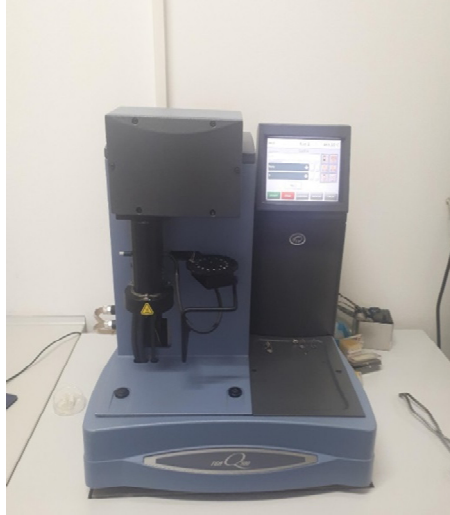
Slika 18. Termogravimetar TA Instruments Q500
