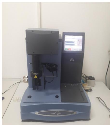
*Slika 18.* Termogravimetar TA Instruments Q500
