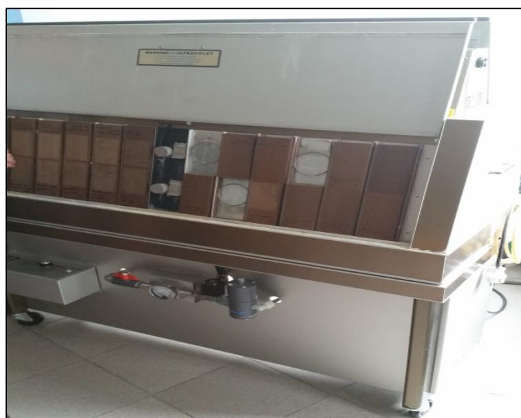
Slika 16. QUV uređaj tvrtke Q-Panel
