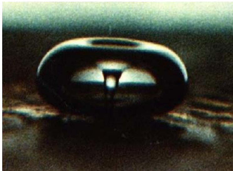
Slika 9. Fotografski prikaz kavitacijskog mjehurića [33]
