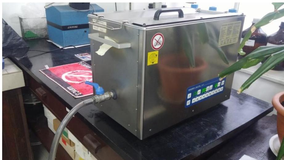
Slika 13. Ultrazvučna kupelj SONOREX DIGITAL 10 P
