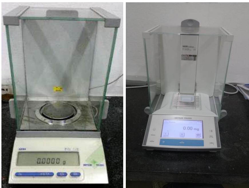
Slika 12. Analitička vaga Mettler Toledo, AB104 (lijevo) i analitička vaga Mettler Toledo, XA105(desno)
