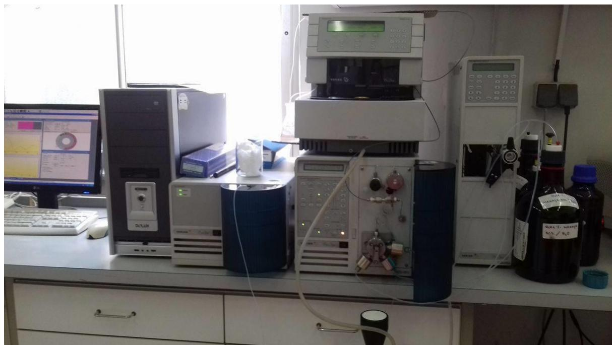
Slika 15. Tekućinski kromatograf visoke djelotvornosti Varian ProStar 500
