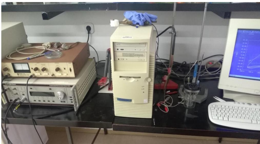
Slika 30. Potencijostat (EG&G Princeton Applied Research, model 263A), osobno računalo i ćelija
