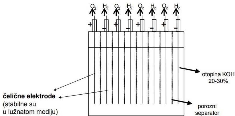
Slika 18. Prikaz šaržnog reaktora za elektrolizu vode.
