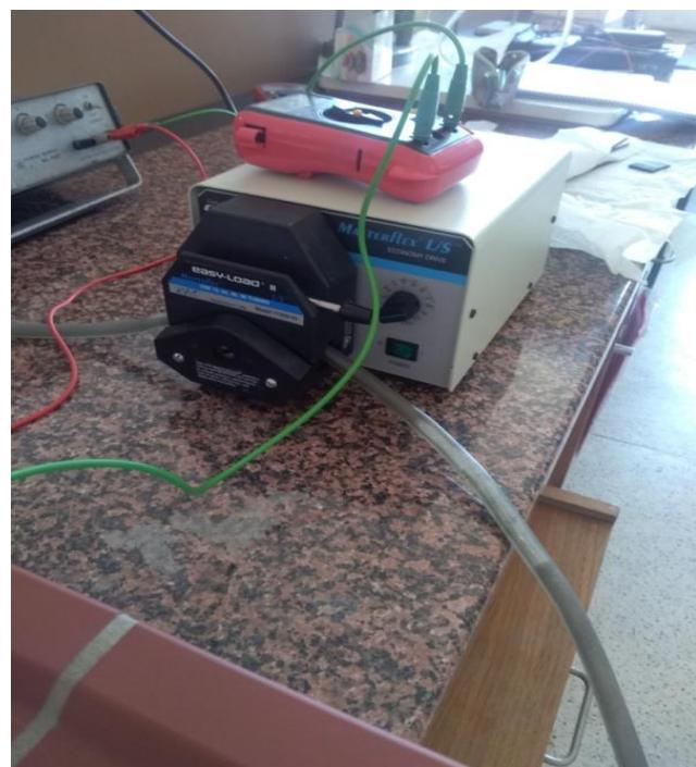
Slika 28. Pumpa i amperometar
