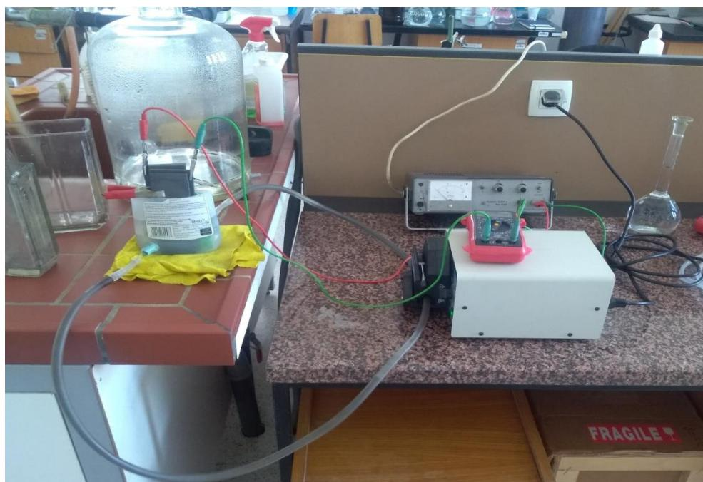
Slika 26 . Aparatura za provođenje kapacitivne deionizacije
