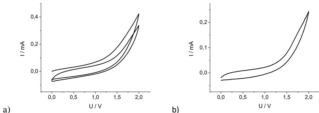
Slika 33. Ciklički voltamografi zabilježeni za grafitne elektrode u dvoelektrodnom sustavu uz brzinu promjene potencijala a)  $50 \text{ mV s}^{-1}$  i b)  $10 \text{ mV s}^{-1}$ .
