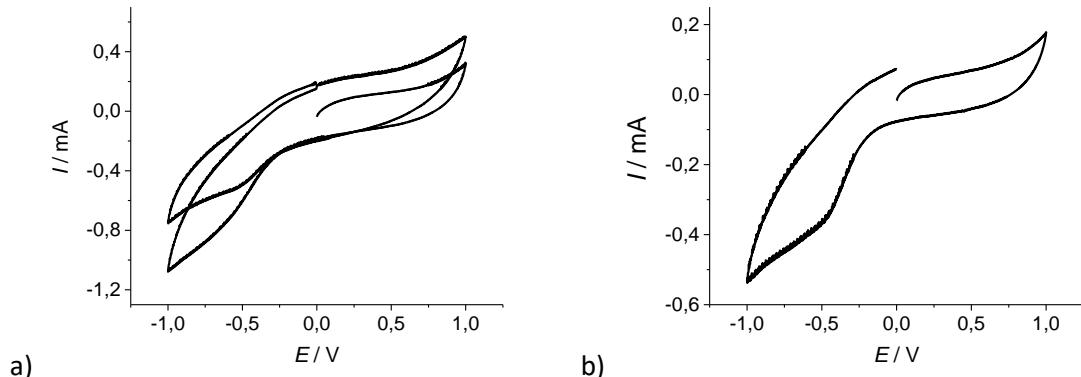
Slika 32. Ciklički voltamogrami zabilježeni za grafitnu elektrodu u troelektrodnom sustavu uz
