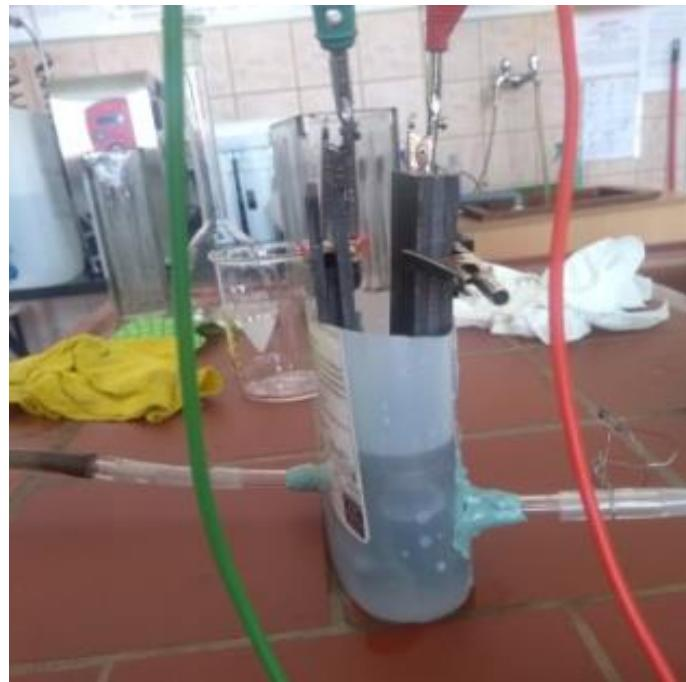
Slika 27. Reaktor s elektrodamama
