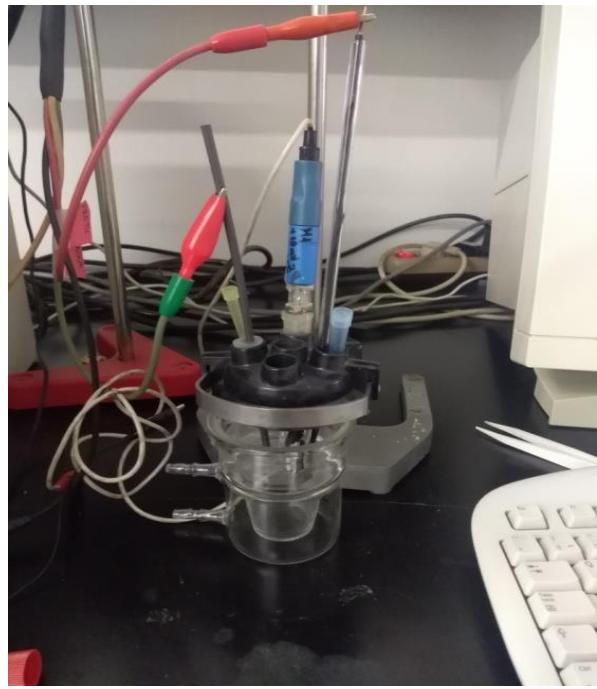
Slika 31. Troelektrodni sustav
