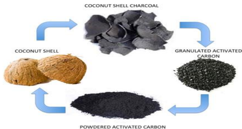
Slika 10. Dobivanje aktivnog ugljika iz kosove ljuske.
