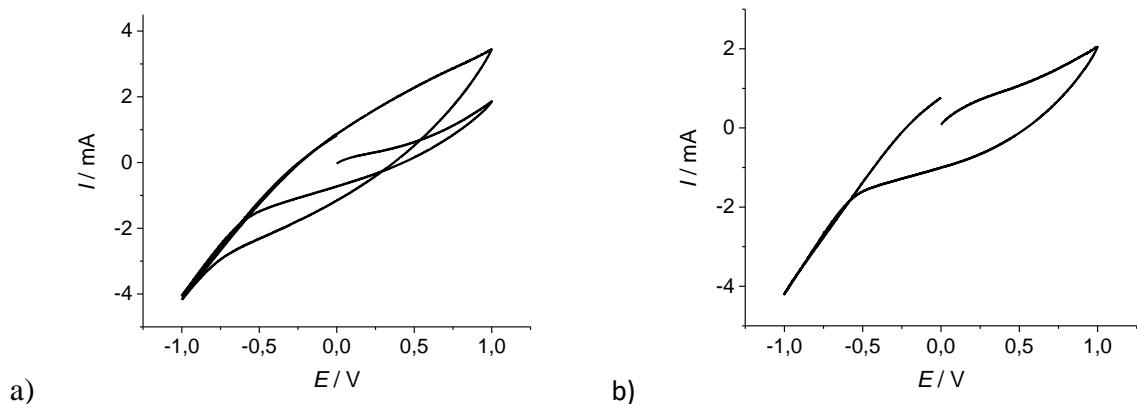
Slika 34. Ciklički voltamogrami zabilježeni za elektrodu premazanu aktivnim ugljikom u troelektrodnom sustavu uz brzinu promjene potencijala a)  $50 \text{ mV s}^{-1}$  i b)  $10 \text{ mV s}^{-1}$ .
