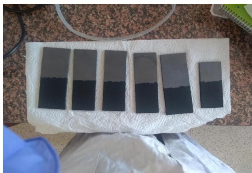
Slika 25 . Elektrode s slojem aktivnog ugljika korištene u eksperimentu. Gornji dio elektroda je čisti grafit, a donji dio je grafit premazan aktivnim ugljikom.
