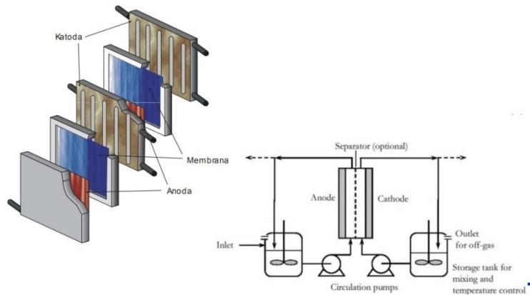
Slika 19. Prikaz protočnog reaktora s paralelnim elektrodama.
