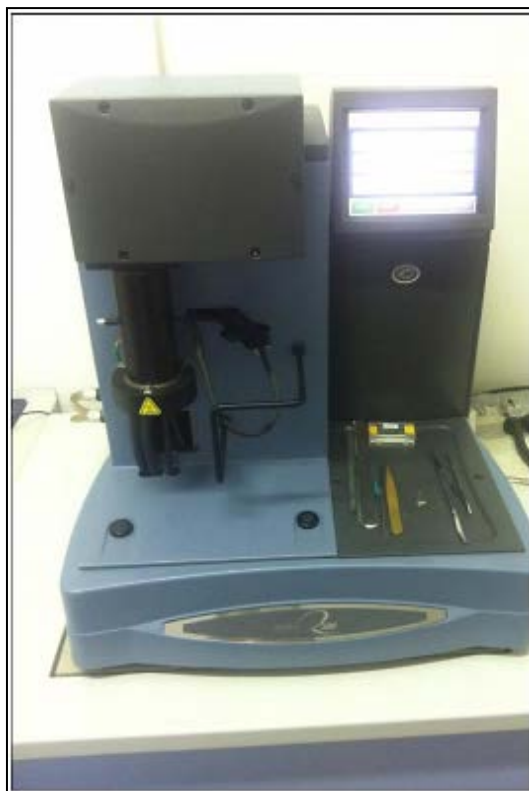
Slika 13. Termogravimetrijski uređaj TA Instruments Q500 na Fakultetu kemijskog inženjerstva i tehnologije
