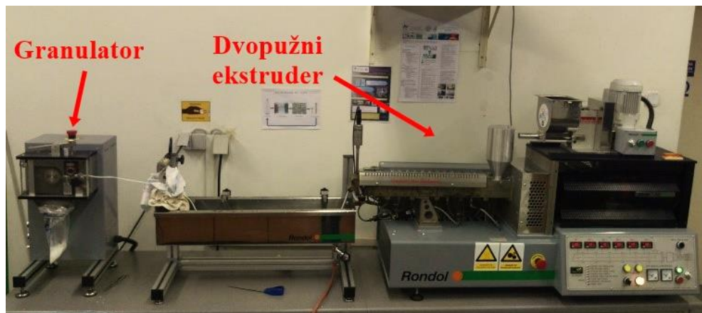
Slika 22. Dvopužni ekstruder Rondol i granulator
